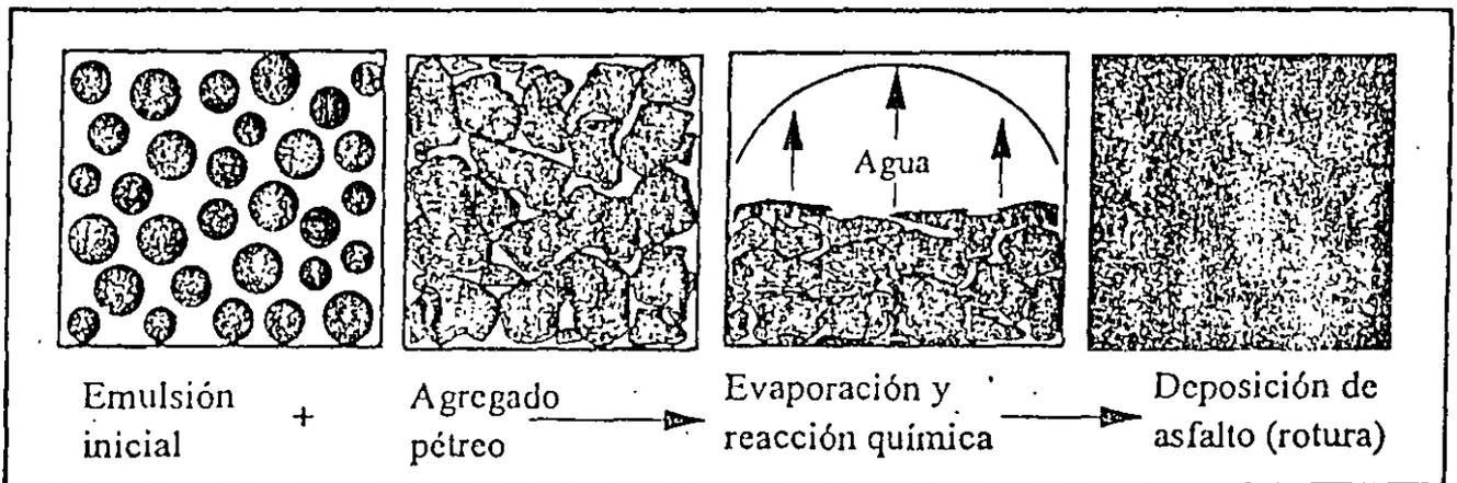
Figura 2.- Rompimiento de una Emulsión Asfáltica
