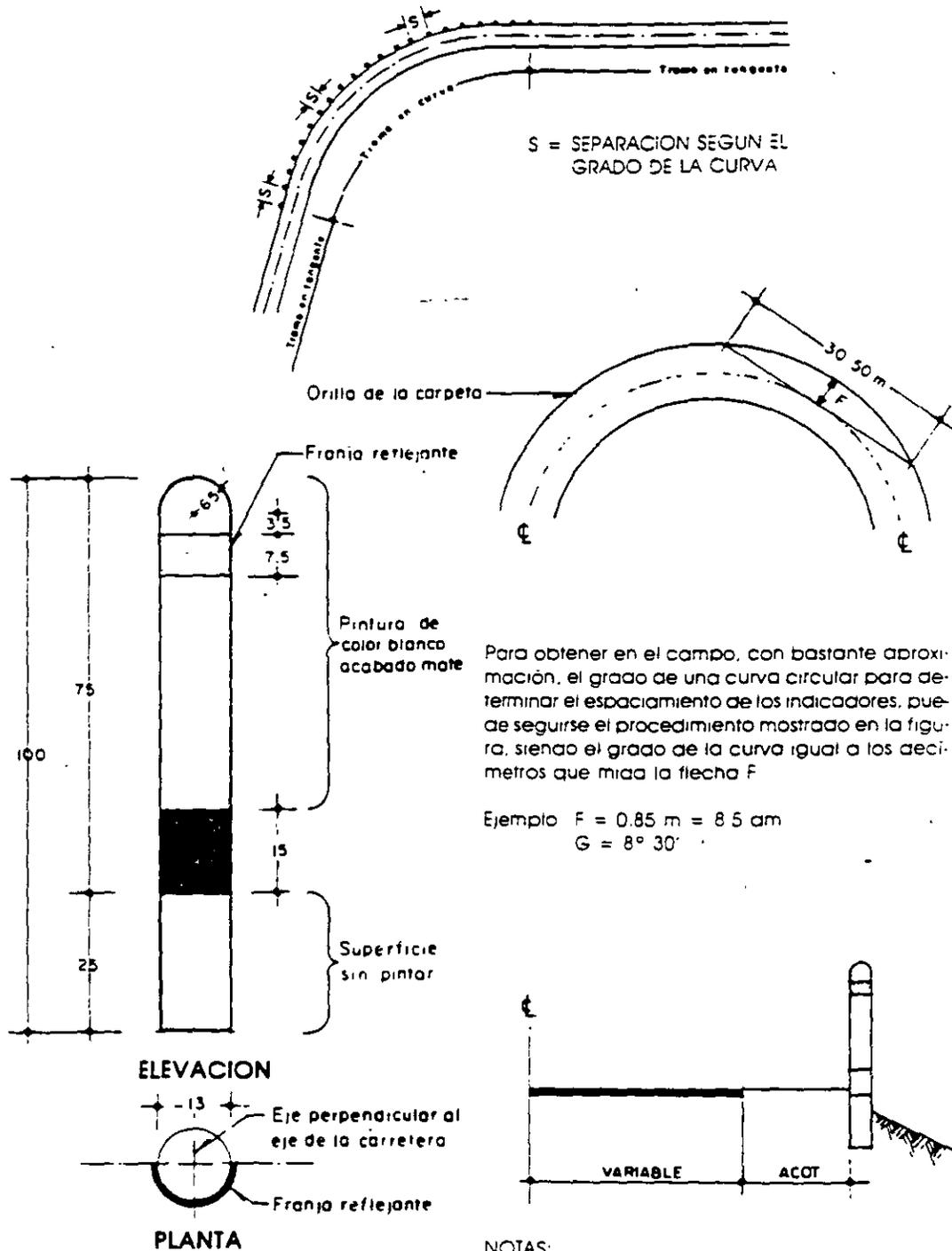
Para obtener en el campo, con bastante aproximación, el grado de una curva circular para determinar el espaciamento de los indicadores, puede seguirse el procedimiento mostrado en la figura, siendo el grado de la curva igual a los decímetros que mida la flecha F
