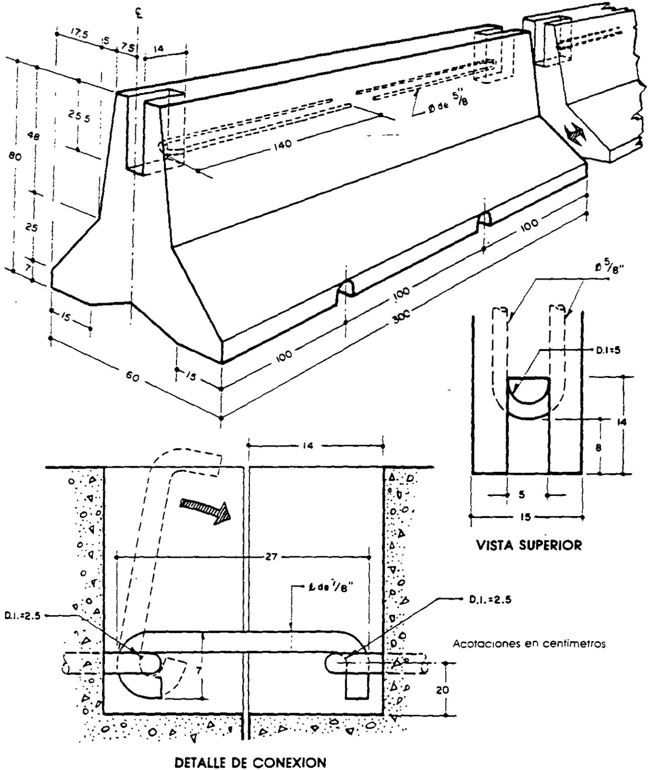
**FIGURA 5.5 FORMA DE ANCLAJE EN LOS EXTREMOS DE DEFENSAS**
