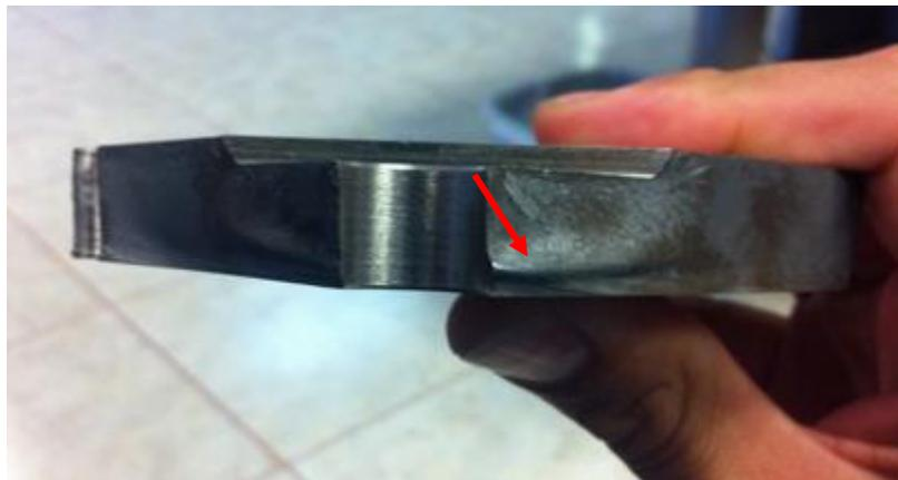
Figura 3.5. Imagen de una sección del plato fracturado.
