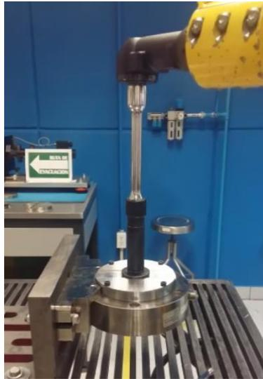
Figura 3.10. Montaje y prueba al nuevo plato de calibración.
