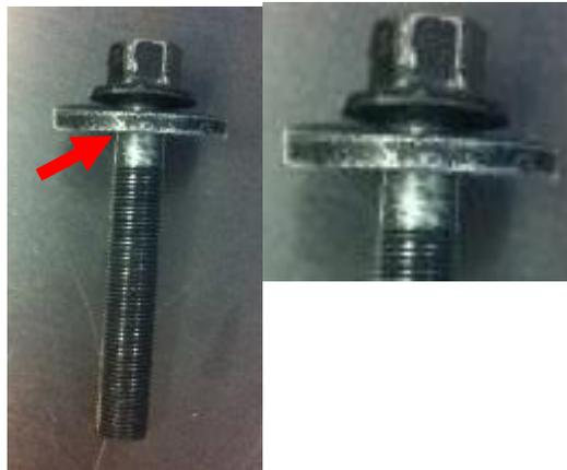
Figura 4.2. Tornillo M16 con acercamiento a la deformación que le ocasionó la prueba.
