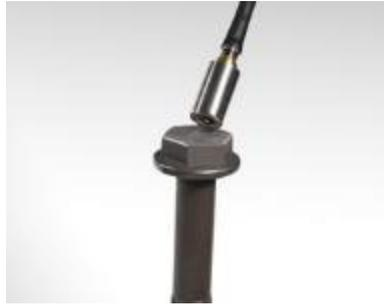
Figura 1.11. Ejemplo de un tornillo preparado para la prueba.
