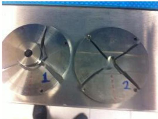
Figura 2.2. Platos de calibración fracturados.
