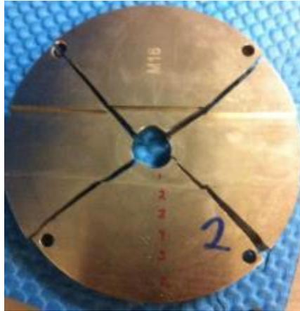
Figura 2.1. Plato de calibración original fracturado.
