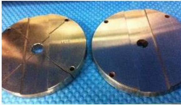
Figura 4.3. Plato fracturado y plato nuevo.
