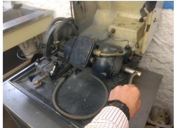
Figura 3-9 Máquina de corte abrasivo BUEHLER
