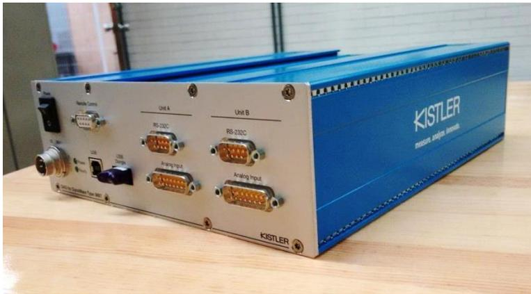
Figura 3-14 Tarjeta de adquisición de datos (Udiatem, Análisis Experimental de los Procesos con Arranque de Viruta, 2016)
