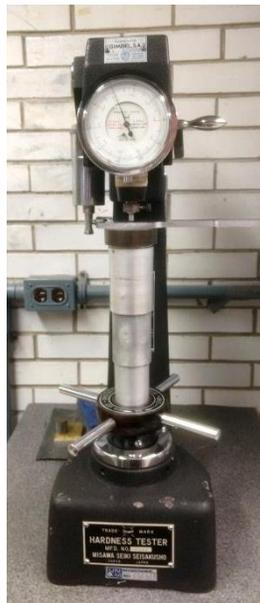
Figura 4-7 Máquina para ensayos de dureza Rockwell
