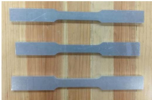
Figura 4-1 Probetas utilizadas en los ensayos de tracción
