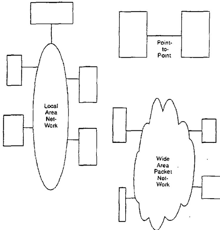
La figura (Fig 2.2) muestra las redes en standalone. Cualquier Host equipado con *TCP/IP* es capaz de comunicarse con otro mediante una línea *punto a punto* que puede ir a una red LAN o WAN.
