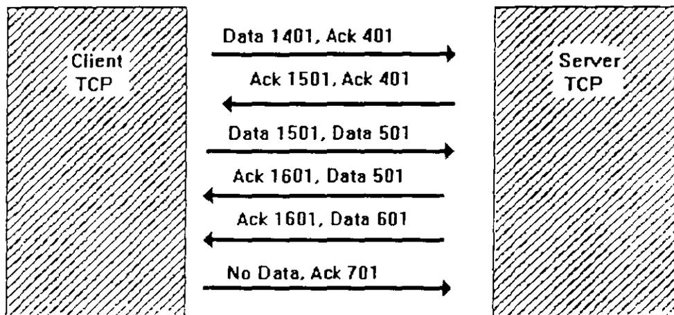
El diálogo continúa en la (fig. 5.9) en la que se muestra un intercambio de datos en ambas direcciones. Cada extremo se encarga de numerar sus propios datos y enviar un ACK por cada dato que ha recibido. Por simplicidad se seguirán utilizando segmentos de 100 bytes
