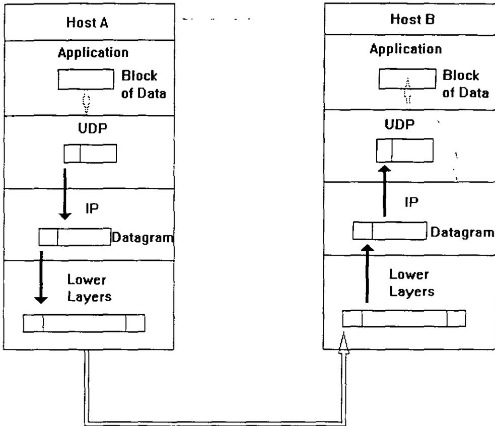
La figura (Fig 2.7) muestra como un bloque de datos se compacta y envía por UDP. Obviamente los mensajes de UDP deben ser enviados tanto por el emisor como por el receptor y el Host B pueden estar concurrentemente en proceso de preparación de un bloque para enviar al Host A.
