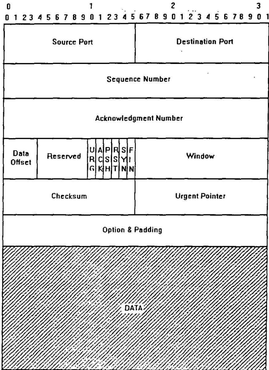
La (fig. 5.11) muestra un segmento, es decir, cabecera de TCP y sus datos. La cabecera de TCP comienza con los identificadores de puerto origen y destino. El campo Número de Secuencia identifica la posición que guardan los datos en una trama de datos de envío en ese segmento. El campo ACK identifica el lugar donde se espera se localizará el siguiente segmento de llegada en la trama de datos a recibir.
