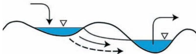
*Figura 2.10 Duna de infiltración*
