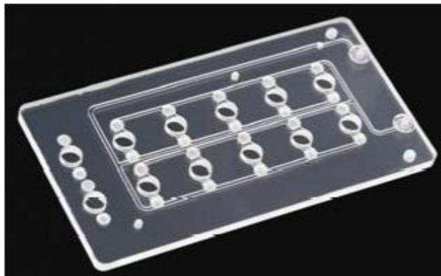
**Figura 8** [6] Carga útil del Gene-Sat 1: dispositivo microfluídico.
