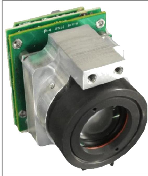
*Figura 4.3 Seguidor de Estrellas [46].*
