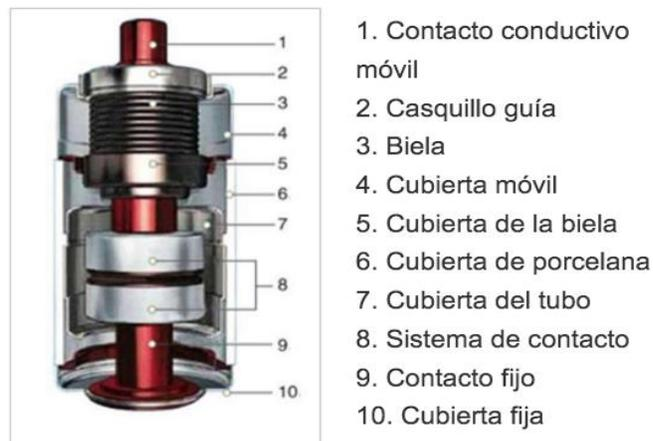
Figura 10. Interruptor en vacío [Polos encapsulados para interruptores de vacío. Recuperado de <http://tellhow-electric.es/9-embdedded-poles/180293>]
