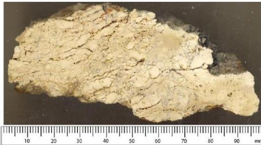
Toba alterada. Presenta fracturas milimétricas rellenas parcialmente de óxidos y sulfatos. Se observan cristales de tamaño menor a un milímetro.
