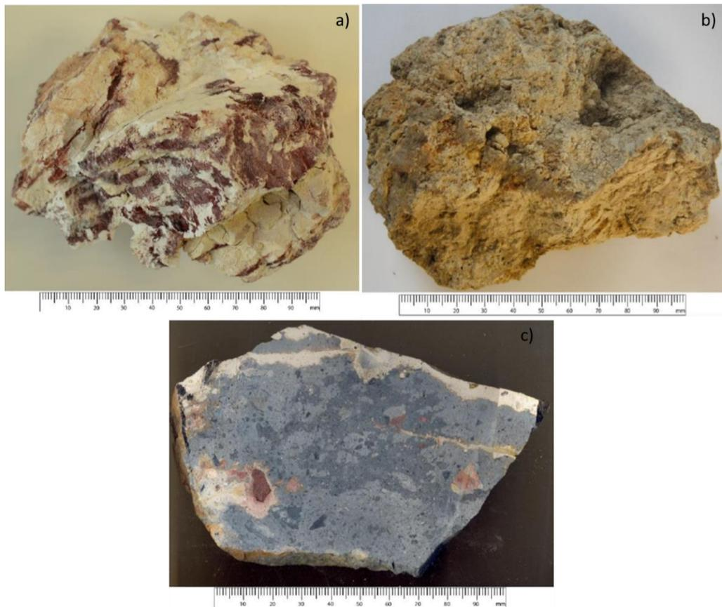
**Figura 4.1.** a) Lava alterada. Presenta intercalaciones de material blanco (caolín?) y rojo (óxidos de hierro). Muestra G-01. b) Toba alterada. Presenta fracturas milimétricas rellenas parcialmente de óxidos y sulfatos. Muestra G-22. c) Toba alterada de lapilli y ceniza de tonalidad gris clara a gris medio. Muestra G-08.
