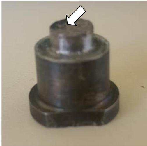
Fig. 25 Probetas de desgaste.
