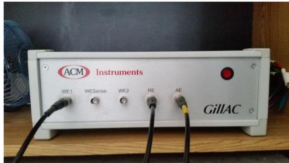
Fig. 33 Potencióstato marca ACM Instruments que se utilizó para hacer las mediciones.
