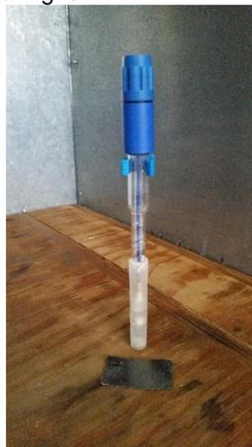
Fig. 34 Electrodo de referencia y contraelectrodo de Grafito.
