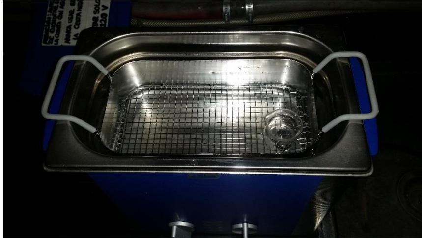
Fig. 27 Limpieza Ultrasónica para las probetas de desgaste.
