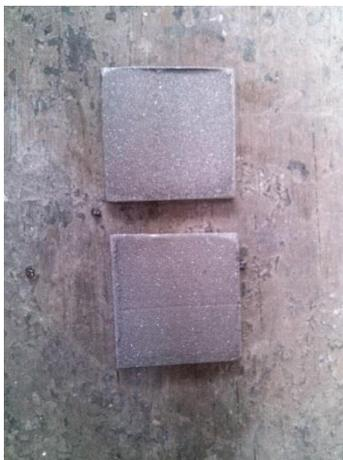
Fig. 20 Probetas granalladas
