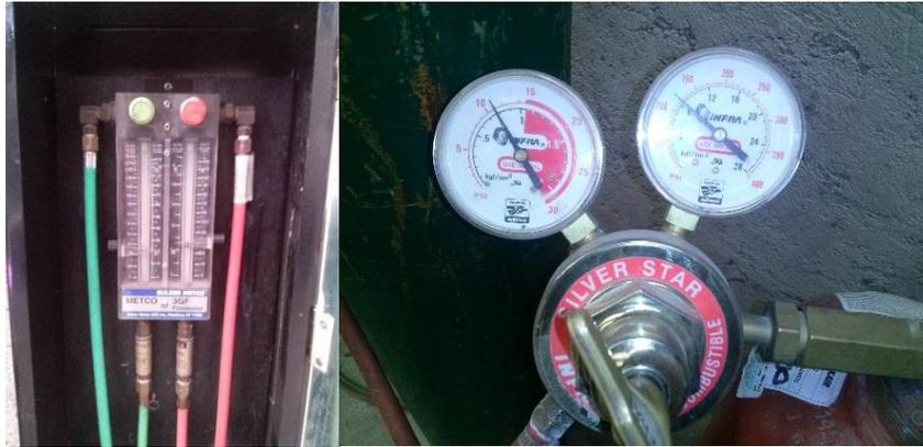
Fig. 24 Dispositivos de medición de gasto y presión de gases.
