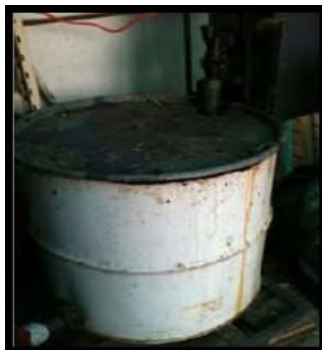
Figura 3.4 Tanque receptor y de preparación de la alimentación al reactor (Grimaldo, 2013)
