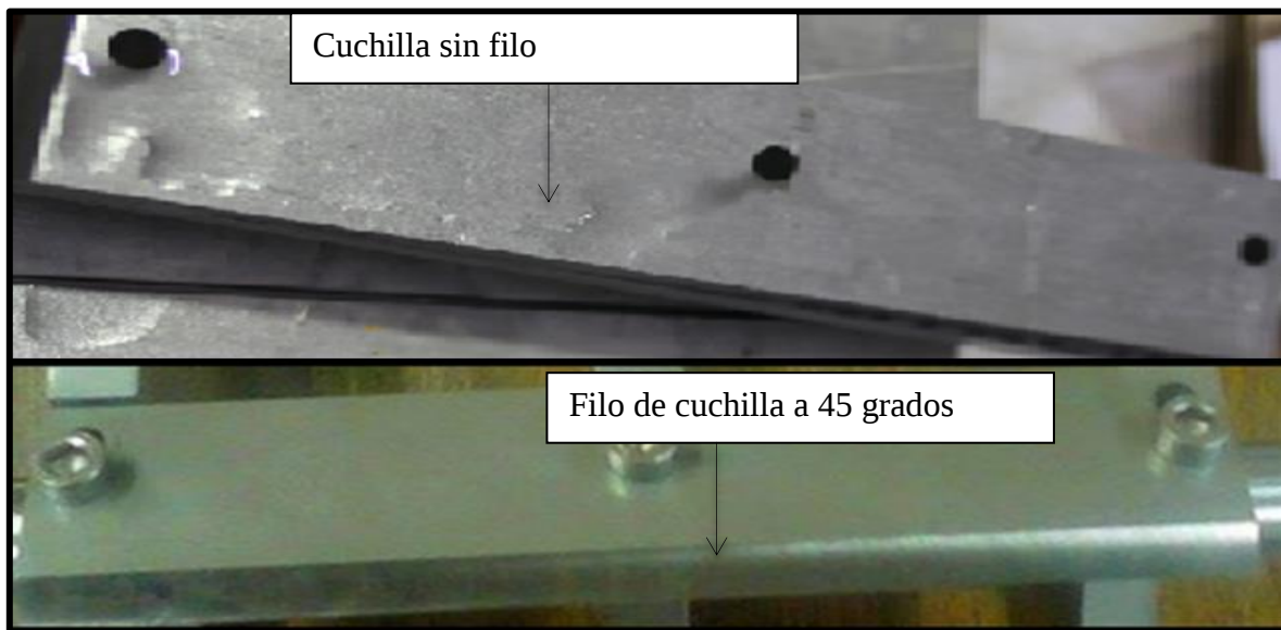
Figura 5.26 Cuchillas maquinadas con filo de 45^\circ
