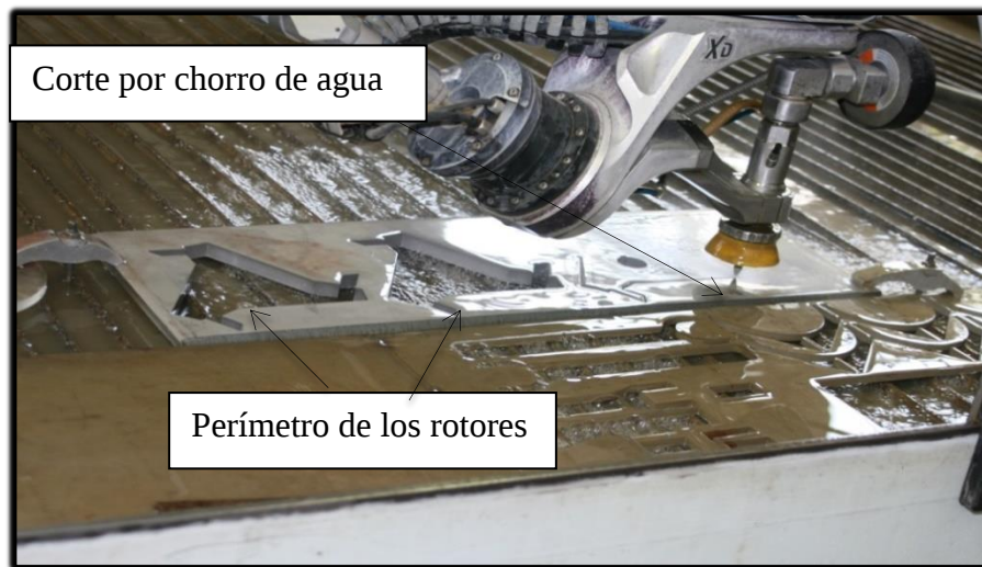
Figura 5.19 Corte de los rotores. CCADET
