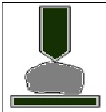
Figura 2.4 Fragmentación por corte (Elaboración a partir de Ramos, 2013)
