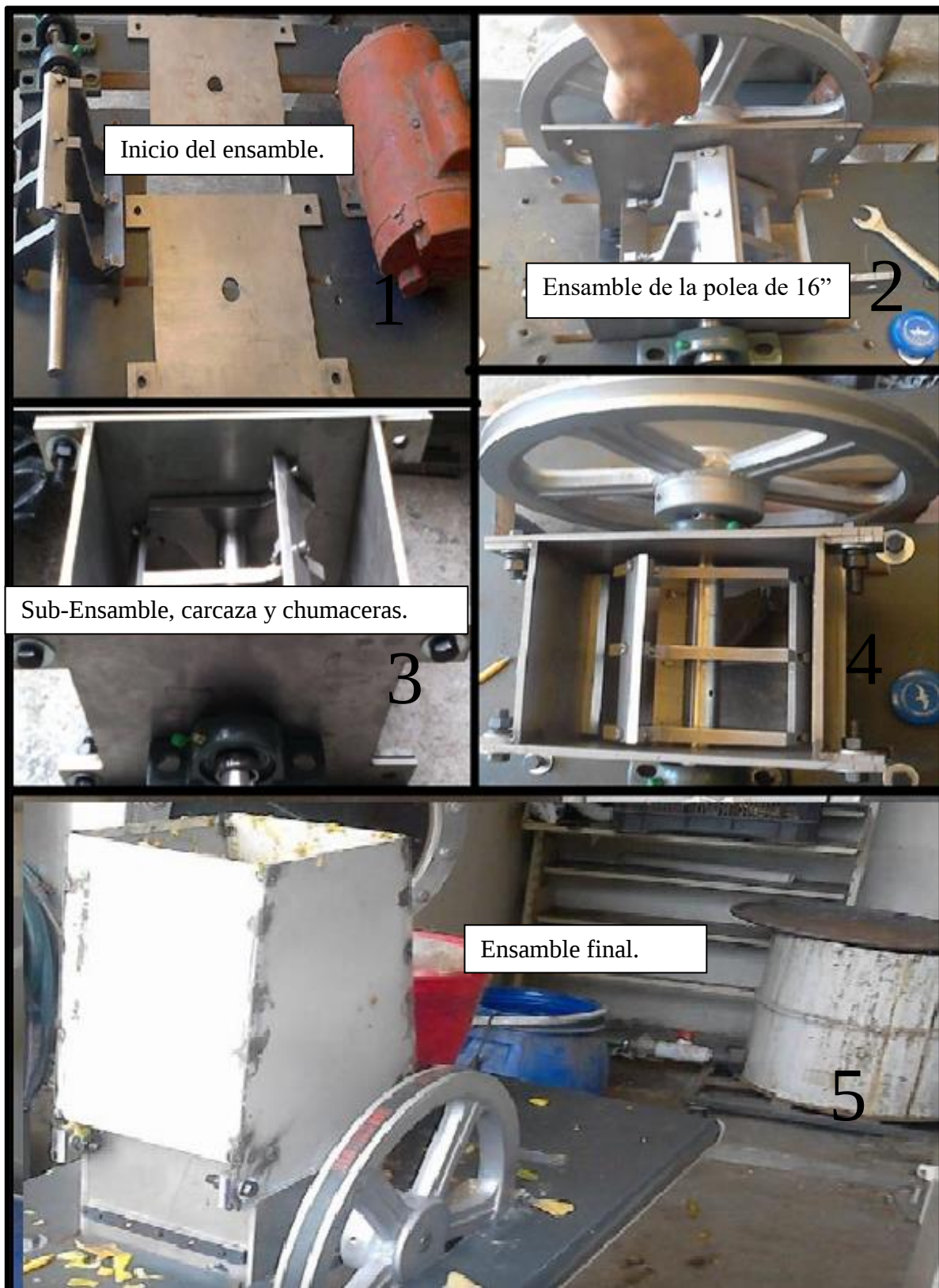
Figura 5.31 Secuencia de ensamble fina
