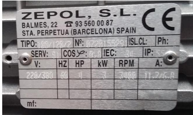
Imagen 13. Placa de datos de motor eléctrico ZEPOL, podemos apreciar un factor de potencia de 0.8 y una potencia de 4 HP (3 kW).
