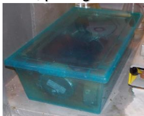
Fig. 7.22 Probetas siendo expuestas a dióxido de nitrógeno.
