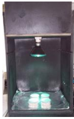
Fig. 7.18 Irradiación de luz UV-A a las probetas.
