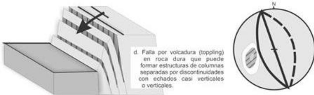
Figura 52. Esquema de una falla por volteo y su representación en la red estereográfica (Dávila M. 2016).
