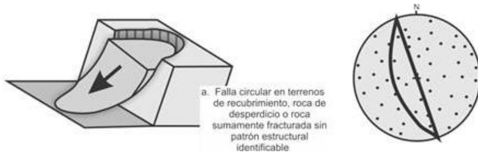
Figura 49. Esquema de una falla de cuchara y su representación en red estereográfica (Dávila M. 2016).
