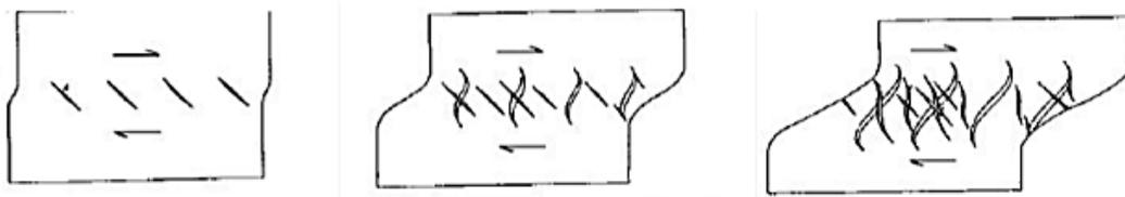
Figura 63. Las vetillas escalonadas y su relación con los bordes de la zona de cizalla. Nótese la formación de distintas generaciones durante la deformación progresiva (Tolson G.).
