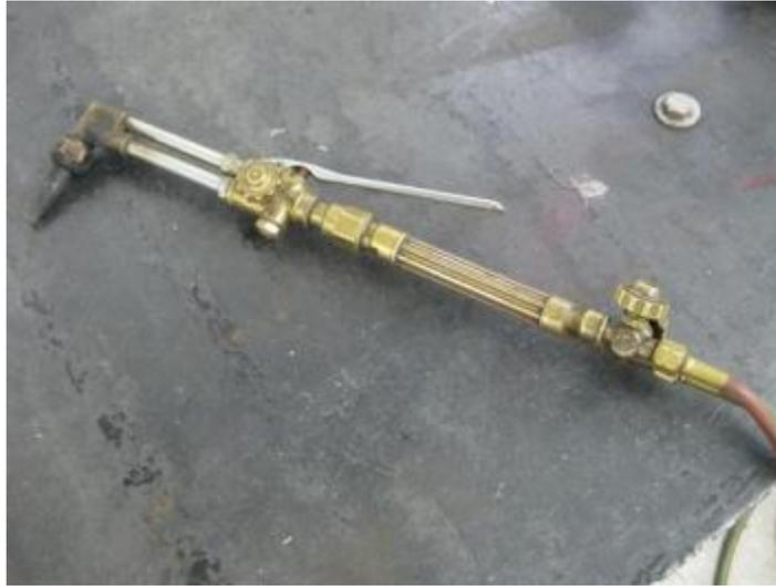
**FIGURA 10.17** Soplete (antorcha) para corte con oxígeno
