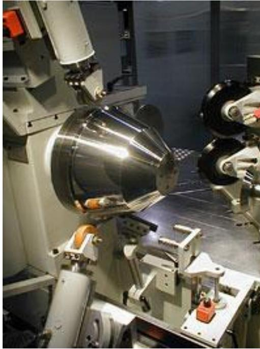
**FIGURA 9.14** La operación de rechazado se realiza al empujar la lámina mediante una o varias herramientas sin filo, sobre el mandril, que se encuentra girando
