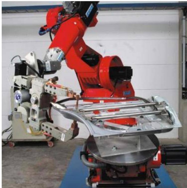
**FIGURA 10.7** Punteado por resistencia eléctrica de una parte automotriz
