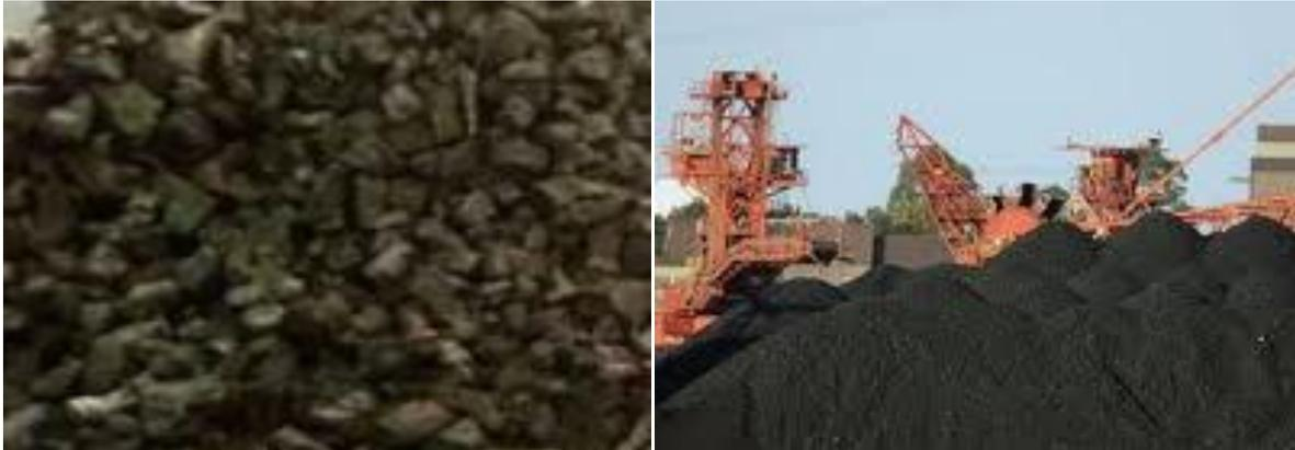
**FIGURA 2.6** El coque es un material poroso de alta resistencia a la compresión. El cual debe contener un mínimo de azufre
