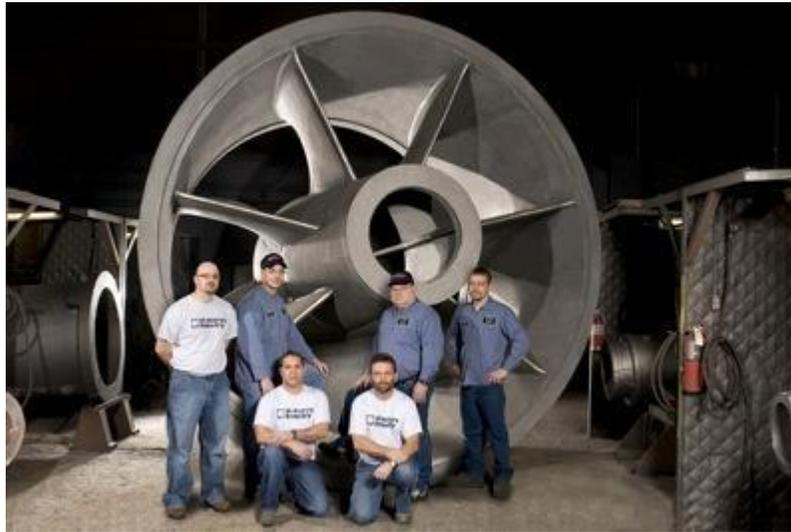
**FIGURA 3.3** Por fundición se pueden producir piezas de decenas de toneladas
