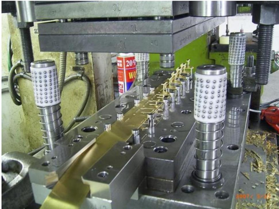
**FIGURA 9.41** Troquel progresivo de 10 etapas para alta producción. Nótese que las guías ya no emplean bujes, sino sistemas antifricción
