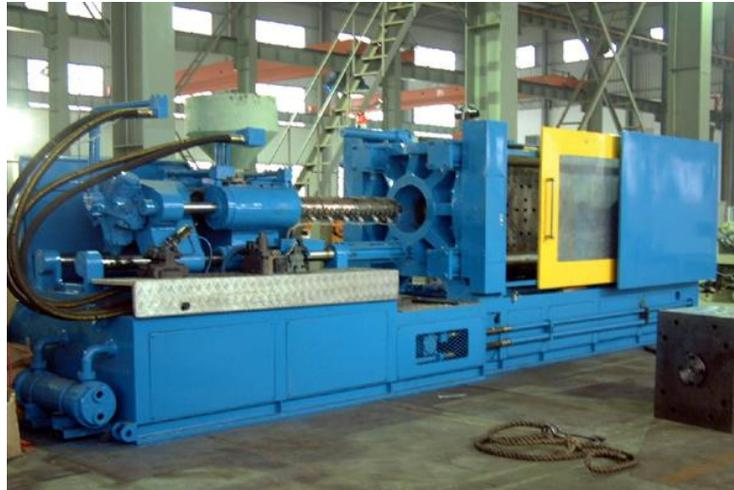
**FIGURA 11.5** Máquina de inyección con fuerza de cierre de 4000 kN, capacidad de inyección de 2400 cm<sup>3</sup>, presión de inyección de 138 MPa y capacidad de plastificación de 132 g/s. La máquina pesa 16 ton y mide 8.6 x1.9 x2.2 m
