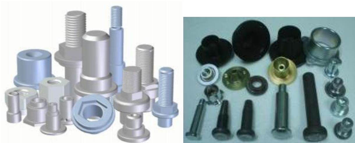
**FIGURA 9.19** Diversas piezas producidas por forja en frío
