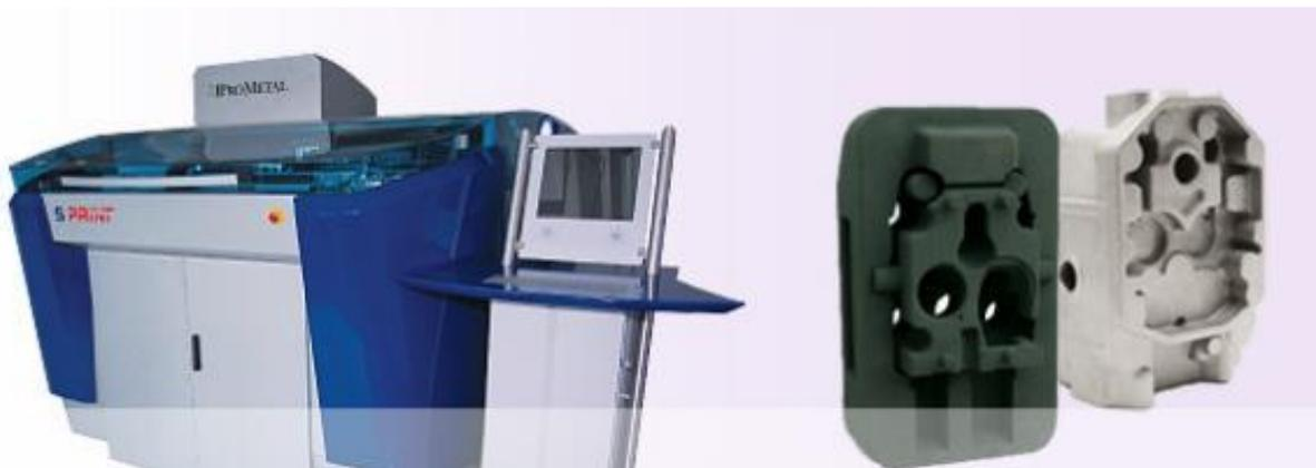
**FIGURA 3.40** Impresora 3d para corazones y moldes en arena. Permite pasar del archivo CAD al molde [prometal RCT<sup>R</sup>]
