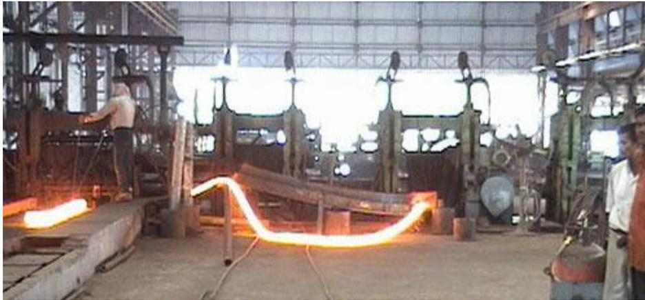
**FIGURA 5.15** Se observa parte de un tren alineado o desplegado en el formador de lazo
