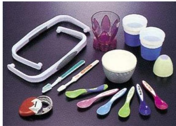
**FIGURA 11.2** Existe una gran variedad de formas, propiedades y aplicaciones de las piezas producidas en plásticos. En este caso se aprecian diferentes piezas producidas por inyección
