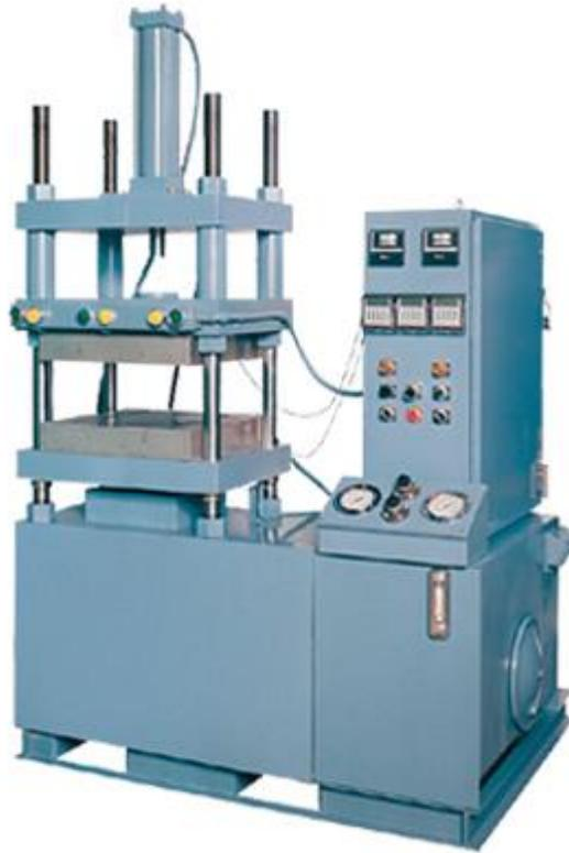
**FIGURA 11.19 (b)** Prensa para moldeo por compresión
