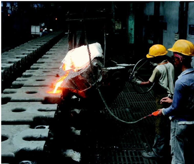
**FIGURA 3.19** Vaciado de los moldes en un carrusel
