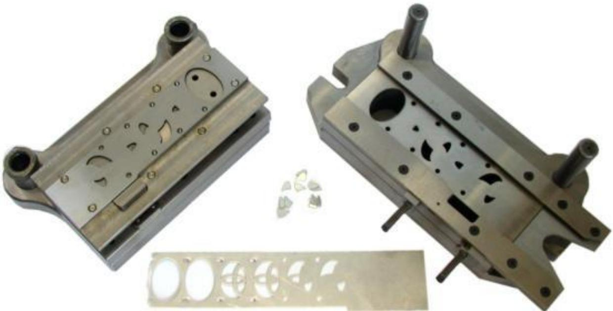
**FIGURA 9.48** Troquel progresivo y cinta en donde se observan las diferentes etapas del troquelado
