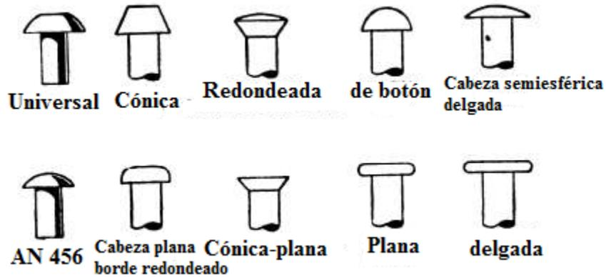
**FIGURA 10.40** Diferentes tipos de remaches
