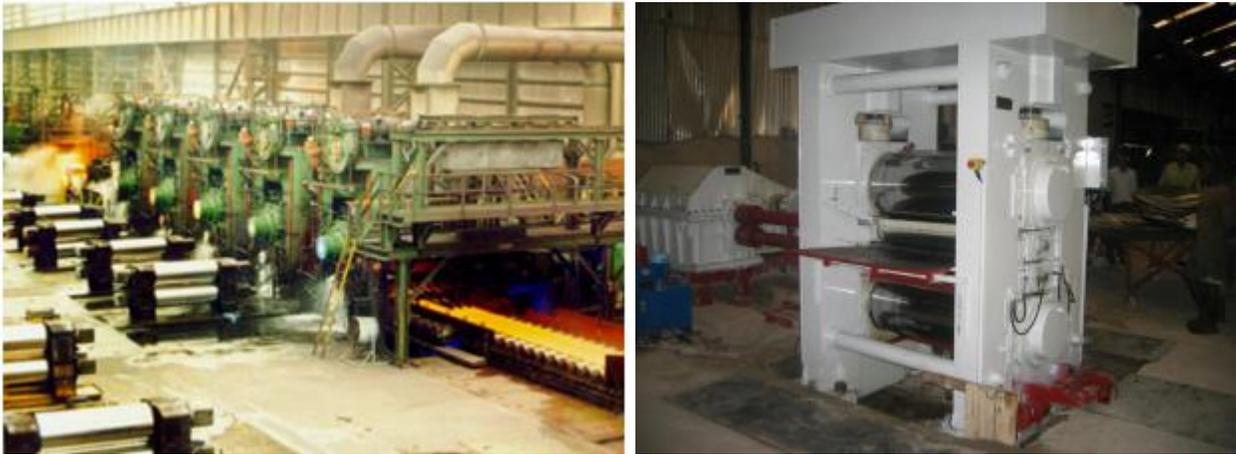
**FIGURA 5.8** En la figura de la izquierda se observa un tren de laminación en caliente, del lado derecho se tiene una laminador cuarto para operaciones de calibrado de espesor
