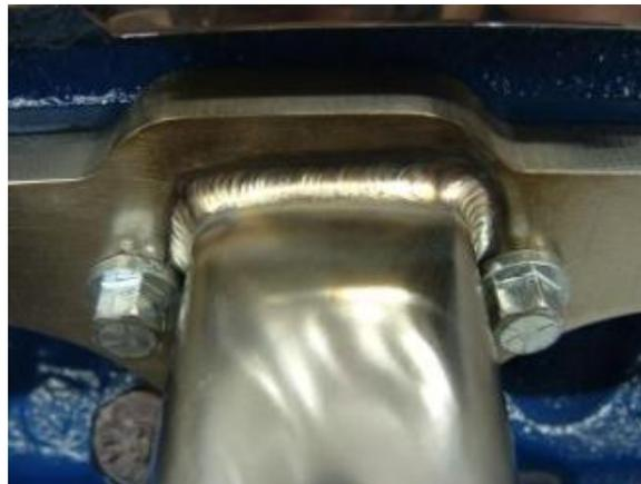
**FIGURA 10.21** En la figura de la izquierda se observa el proceso de soldadura TIG de un radiador de aluminio. La figura de la derecha muestra la calidad del cordón efectuado en piezas de acero inoxidable
