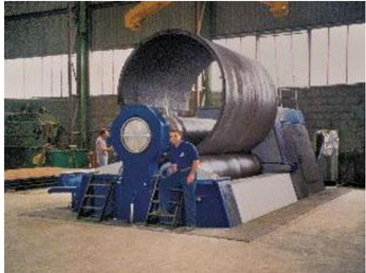
**FIGURA 9.27** En la imagen de la izquierda se muestra esquemáticamente el proceso de relado de chapa metálica; a la derecha se presenta una rodadora mecánica para placa de 10 a 35 mm de espesor y hasta 4 m de ancho
