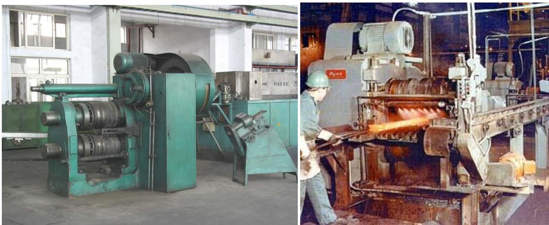
**FIGURA 6.9** Equipo para forja con rodillos
