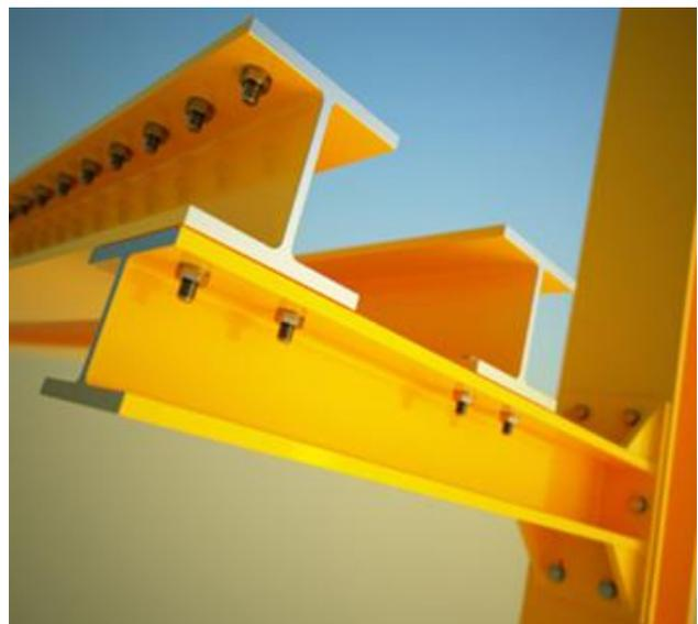
**FIGURA 7.35** Perfiles estructurales obtenidos por laminación
