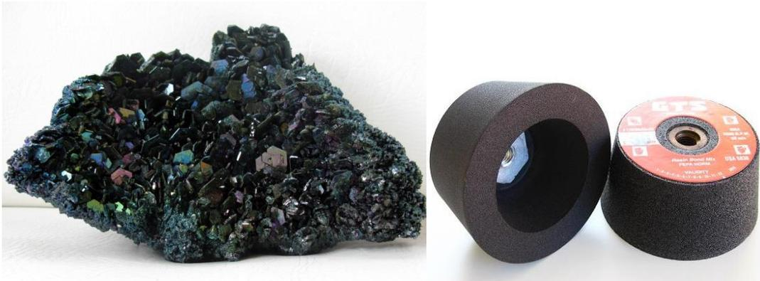
**FIGURA 12.7** Cristales de  $SiC$  (Imagen tomada de wikipedia, John Faithfull, 2010). Ruedas abrasivas tipo copa de carburo de silicio.
