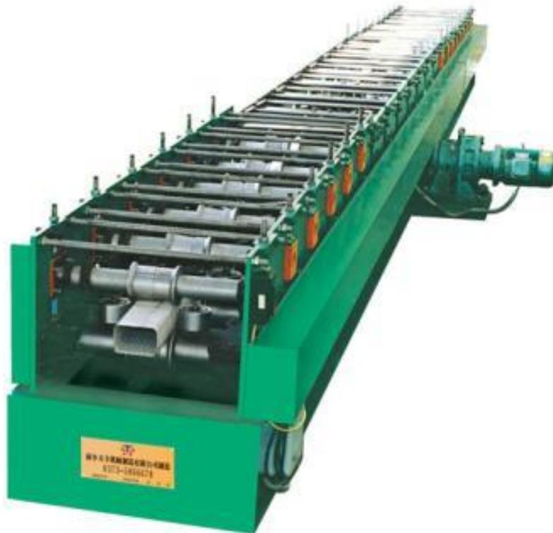
**FIGURA 9.23** Formado por rodillos de perfiles tubulares
