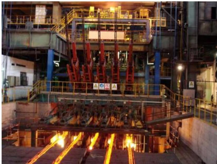
**FIGURA 2.28** Planta de colada continua de palanquilla de 5 hilos
