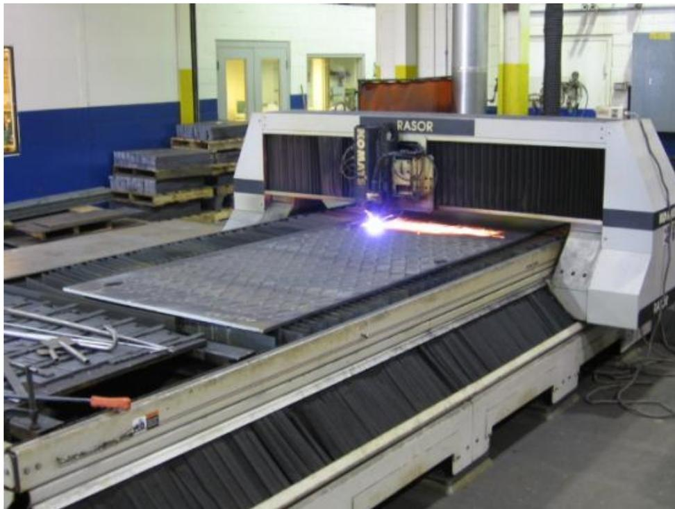
**FIGURA 10.28** Máquina CNC para corte con plasma
