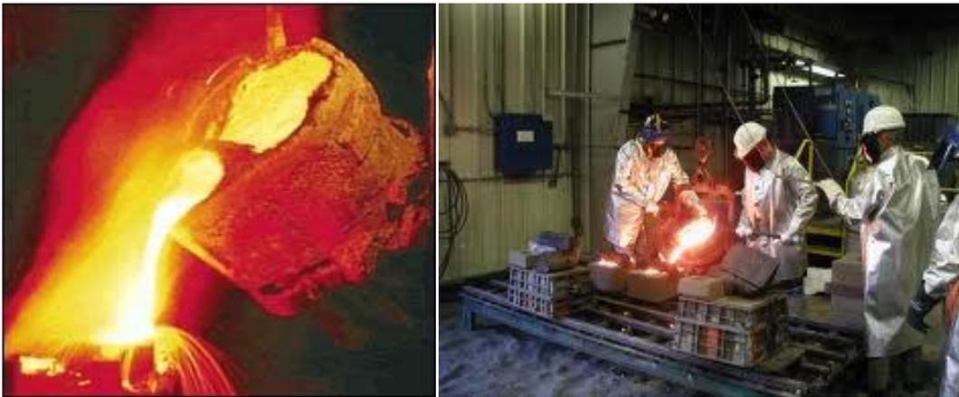
**FIGURA 3.32** Vaciado del metal en el molde
