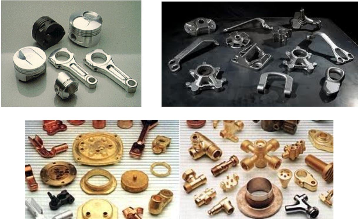
FIGURA 6.17 Diversas piezas producidas por forja en metales no ferrosos
