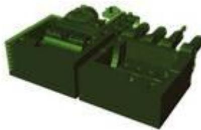
(e) Se remueve la arena que no se ha adherido y se ensamblan las piezas en el molde para proceder al vaciado
