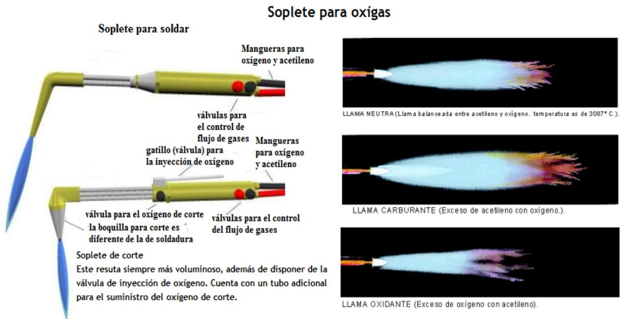
**FIGURA 10.15** Soplete (antorcha) para soldadura y para corte
