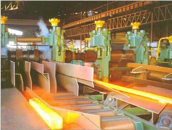
**FIGURA 7.34** Laminador alineado o desplegado empleado para la laminación de barras (instalado en Gujarat, India).
