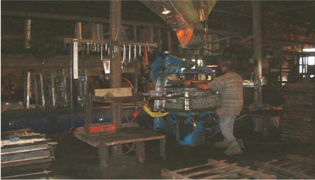
**FIGURA 3.20** Moldeo en verde con moldeadoras neumáticas
