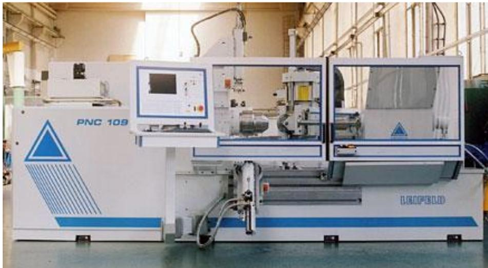
**FIGURA 9.15** Torno de CNC para rechazado
