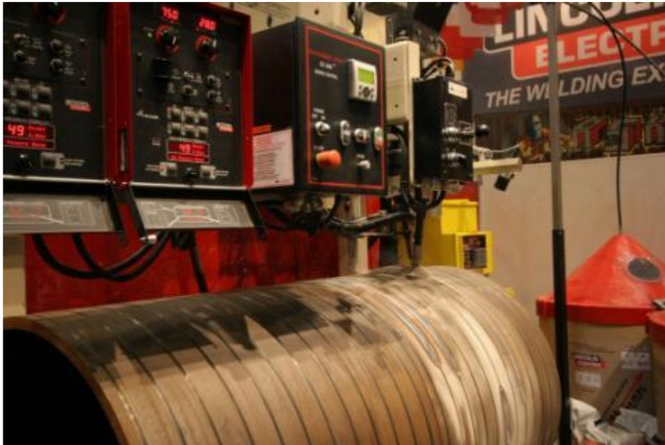
**FIGURA 10.32** Demostración de un equipo de soldadura de arco sumergido que es utilizado para la unión de tubos
