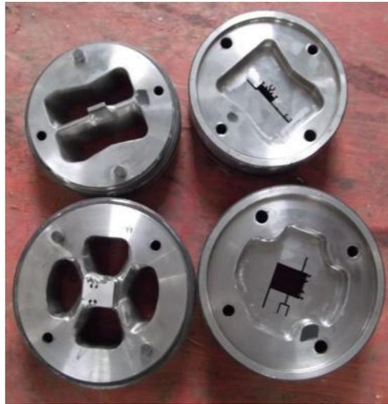
**FIGURA 8.3** Se presentan dos ejemplos de dados para la extrusión de aluminio de perfiles de geometría compleja
