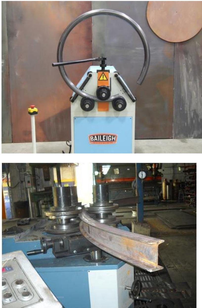
**FIGURA 9.29** Rolado de barra o perfiles [imagen izquierda Perfiles y Herrajes la Soledad, Nvo León Mex]
