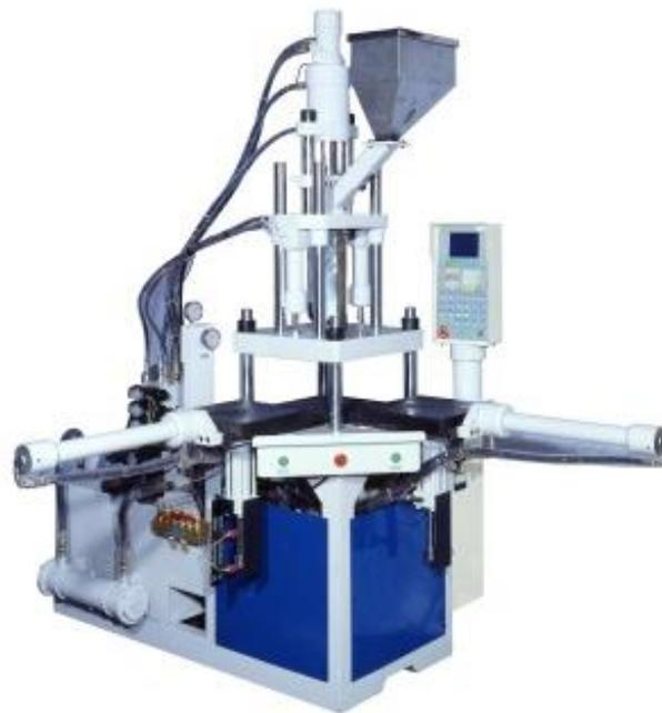
**FIGURA11.7** Inyectora vertical para plásticos, 120 g de capacidad de inyección hasta 2000 bar, fuerza de cierre 550 kN, peso de la máquina 2200 kg, dimensiones; 1.75 x2.40 x2.45 m
