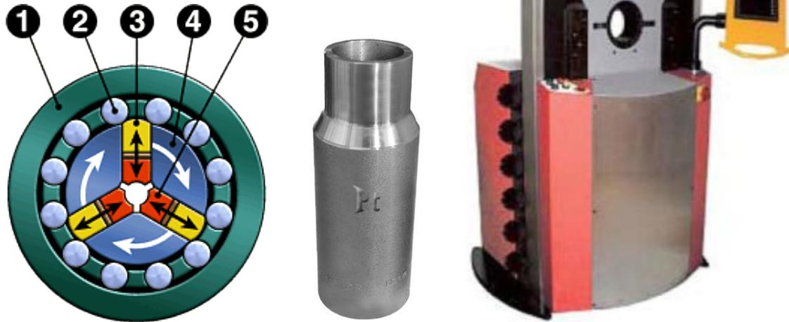
**FIGURA 9.20** En la imagen de la izquierda se muestra esquemáticamente la operación de una suajeadora rotatoria, en la imagen del centro se presenta un niple producido por suajeado; mientras que en la de la derecha se observa un equipo hidráulico para suajeado
