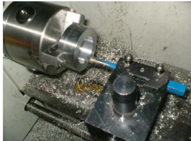
**FIGURA 5.25** Operación de cilindrado exterior e interior
