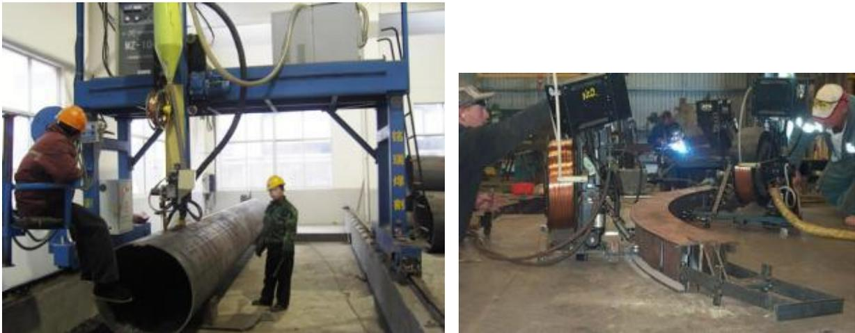
**FIGURA 10.31** Operaciones de soldadura de arco sumergido
