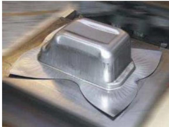
**FIGURA 5.21** La geometría irregular y la propia anisotropía del material se traducen en un mayor porcentaje de desperdicio
