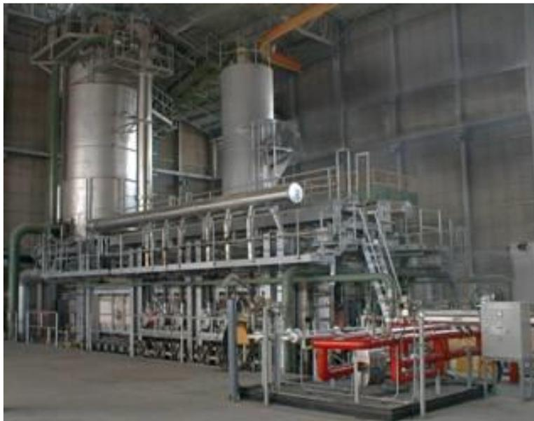
**FIGURA 12.11** Horno para vidrio con recuperadores TECO (Toledo Engineering)
