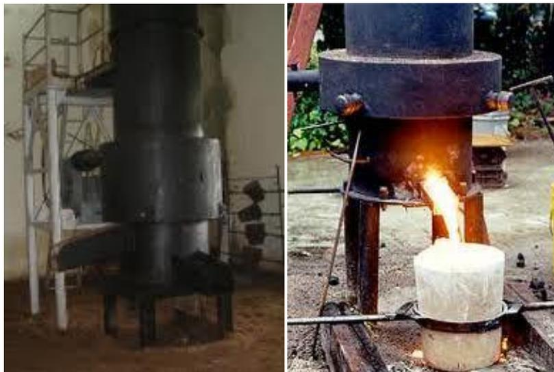
**FIGURA 3.27** Horno de cubilote. Aspectos diversos de dos hornos de pequeña capacidad (alrededor de una tonelada por hora)
