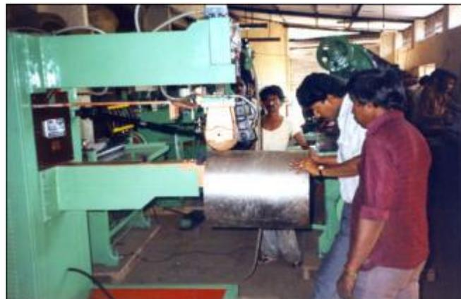
**FIGURA 10.10** Soldadura de costura. En este caso se dispone de dos electrodos en forma de disco los cuales generan una sucesión de puntos
