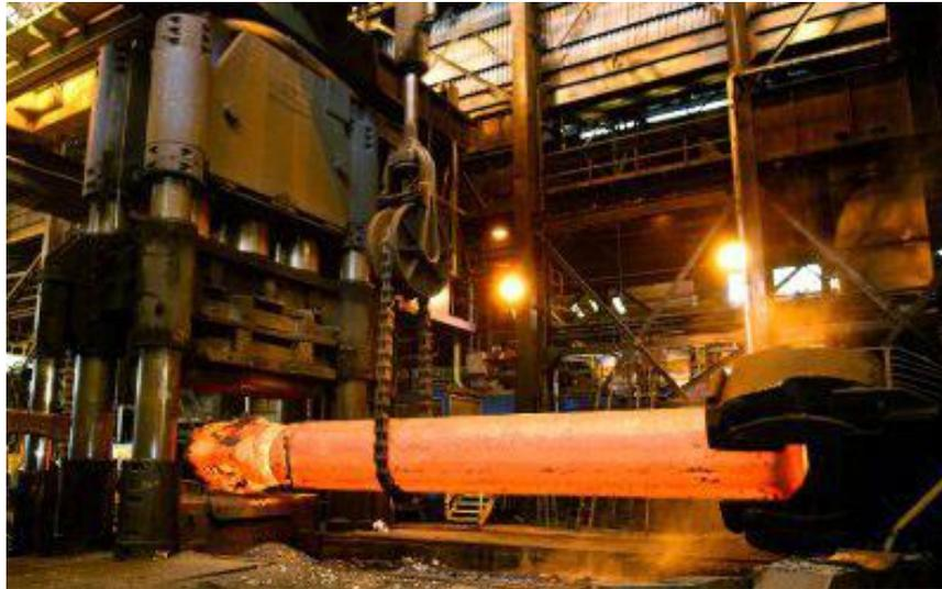
**FIGURA 5.1** Forja abierta en prensa de bastidor abierto
