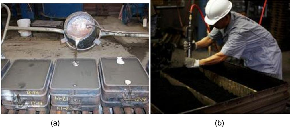
**FIGURA 3.8** (a) Vaciado de aluminio en moldes de arena en verde. (b) Compactado de la arena alrededor del modelo
