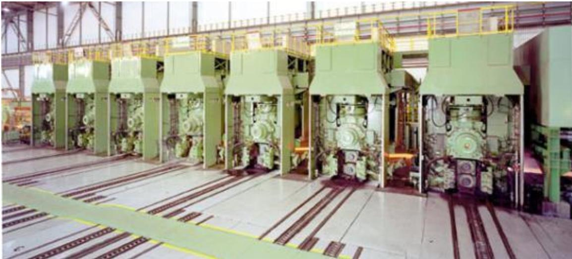
**FIGURA 5.14** Tren de laminación continuo (7 cajas)
