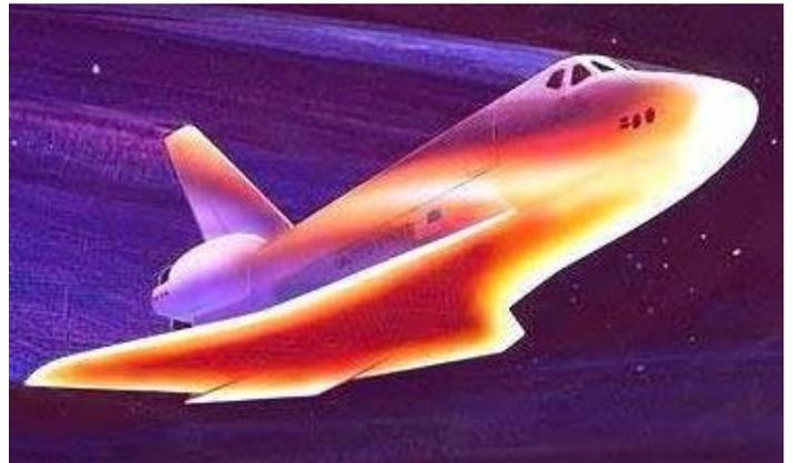
**FIGURA 12.4** Durante el reingreso a la tierra parte de la energía cinética de la nave se transforma en calor, por lo que esta debe disponer de escudos cerámicos refractarios con una elevada resistencia a la temperatura y al desgaste
