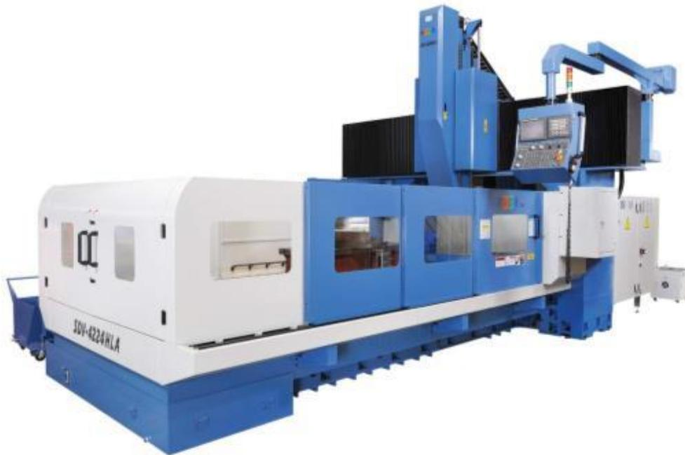
**FIGURA 5.38** Centro de maquinado de CNC
