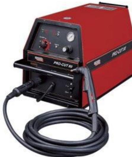
**FIGURA 10.26** Equipo manual para corte con plasma, con una capacidad de 65 A, a 100% de ciclo de trabajo (a 60% de ciclo de trabajo permite 80 A). Se debe recordar que el ciclo de trabajo es el tiempo en que el equipo puede estar en plena operación en un intervalo de 10 min
