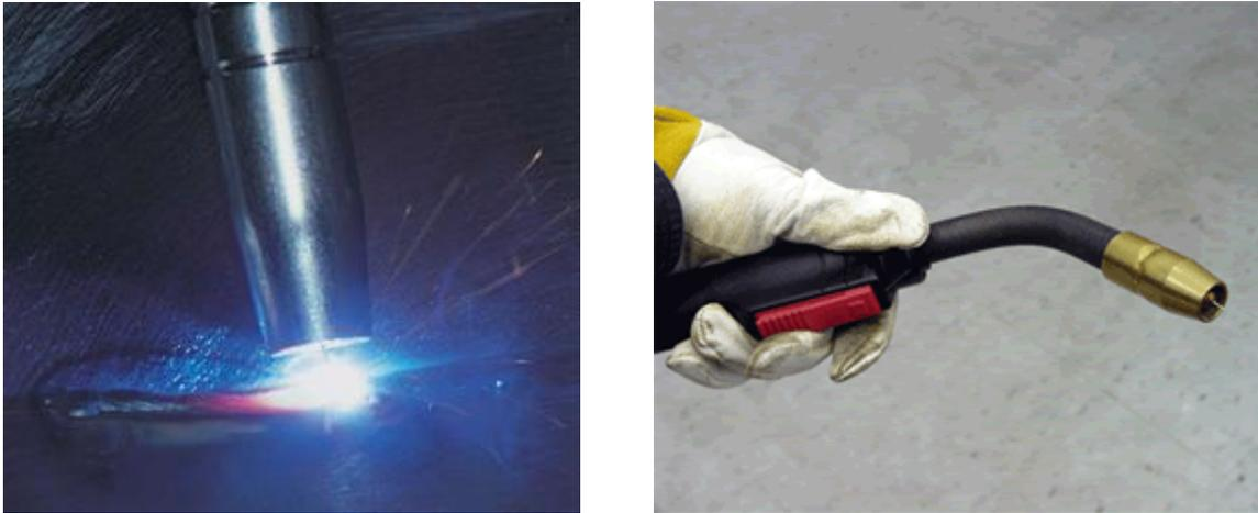
**FIGURA 10.23** El depósito del material en el proceso MIG se da en una forma suave con mínimas salpicaduras y con una elevada velocidad de transferencia, obteniendo un cordón de muy alta calidad y buena penetración. A la derecha se observa una antorcha para trabajo manual
