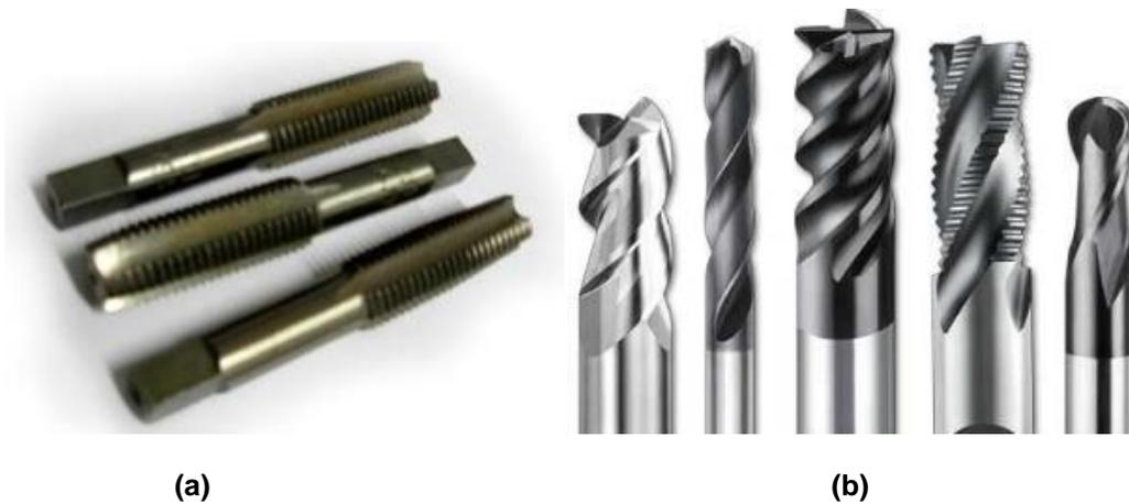
**FIGURA 5.36** Diferentes tipos de herramientas enterizas (de un solo material), (a) machuelos de acero rápido; (b) cortadores verticales de carburo de tungsteno
