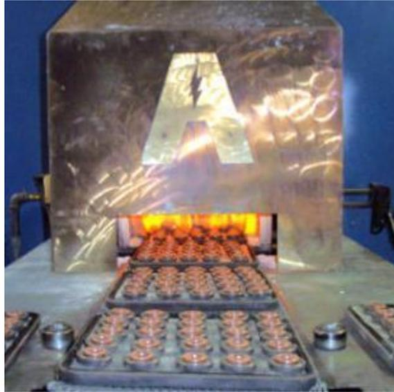
**FIGURA 4.11** Horno de sinterizado
