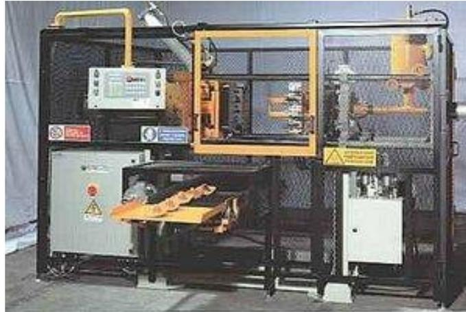
**FIGURA 3.24** Máquina sopladora de corazones de caja caliente
