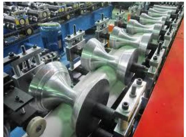
**FIGURA 9.25** El formado con rodillos permite la producción de láminas acanaladas (izquierda). A la derecha se observa la secuencia de deformación de un tren de rodillos
