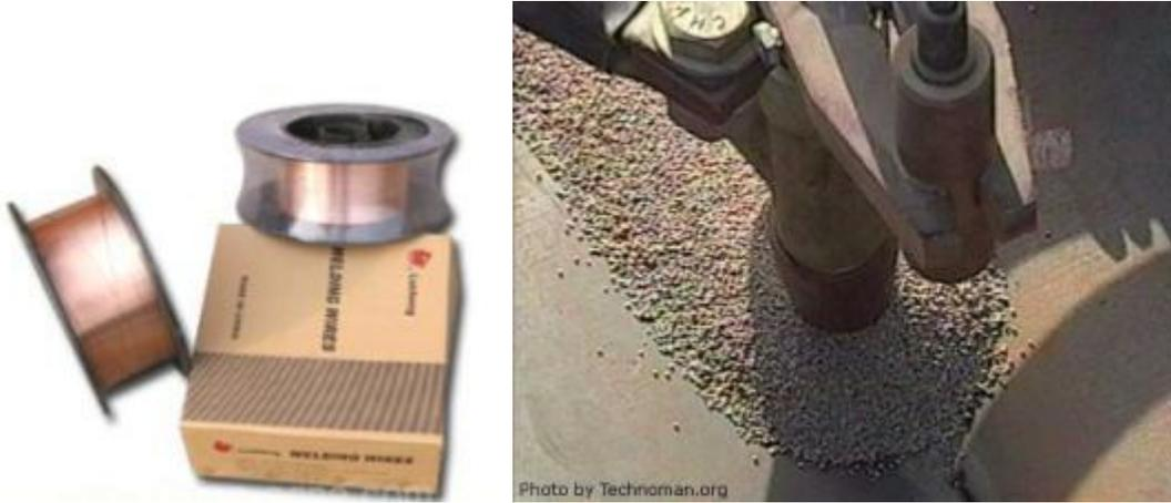
**FIGURA 10.30** Material de aporte para el proceso de soldadura de arco sumergido. El cobrizado del alambre de acero es para mejorar el contacto eléctrico y evitar la formación de herrumbre durante su almacenaje. A la derecha se observa la boquilla que suministra el fundente y su aspecto
