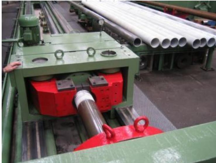
**FIGURA 9.12** Mesa hidráulica de estirado para tubo
