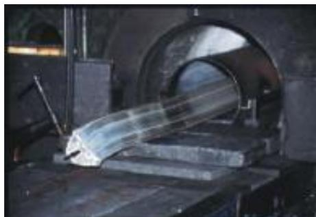
**FIGURA 8.8** Prensas de extrusión horizontal y detalle de perfil extruido.
