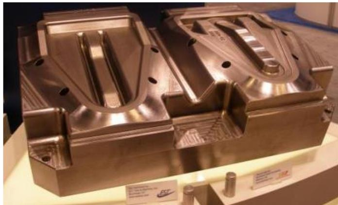
**FIGURA 6.23** Diferentes dados para forja de acero
