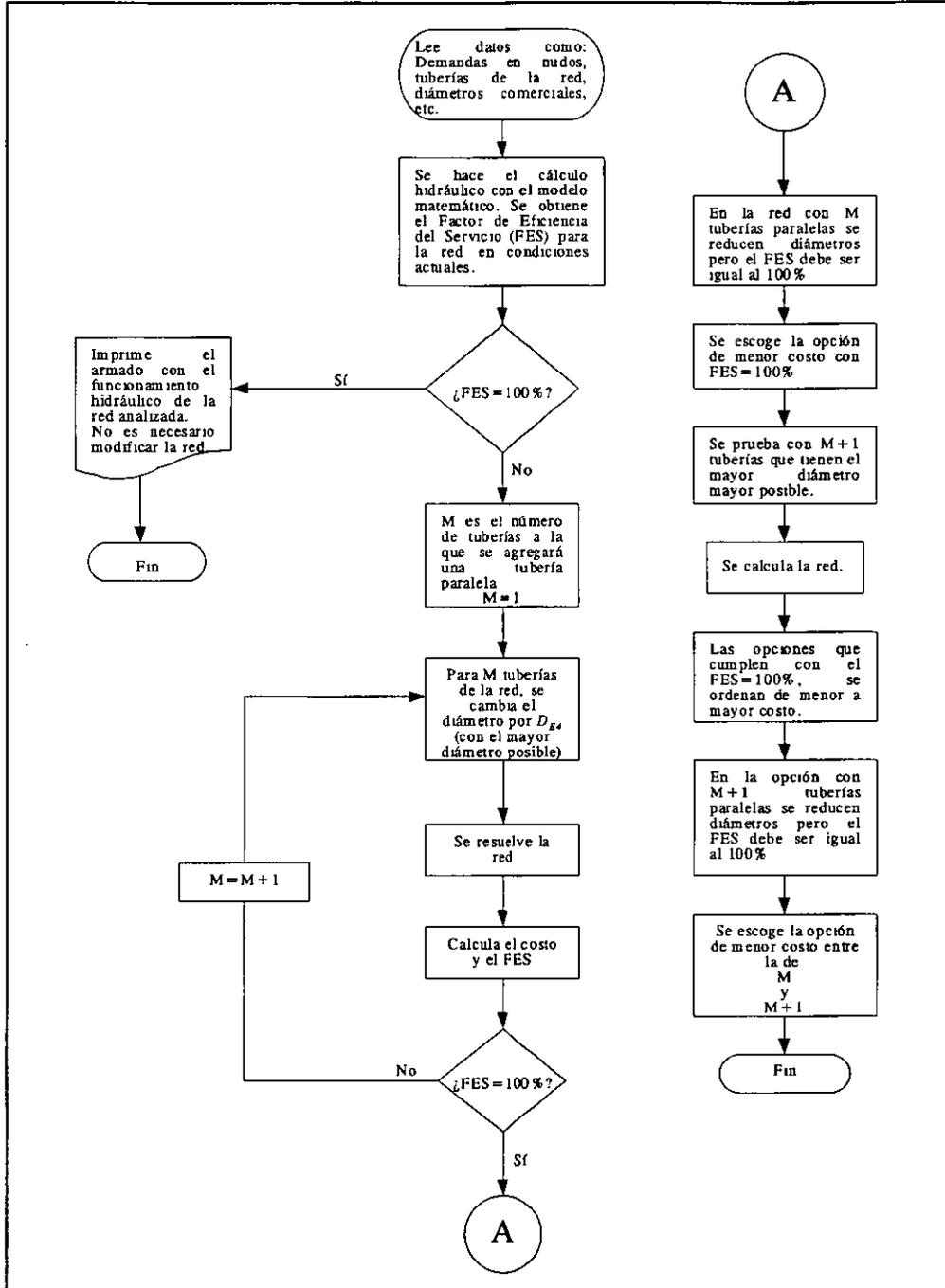
Figura 9.4 Diagrama de bloques para obtener la opción que llegue al valor del FES = 100%.
