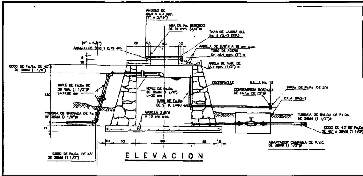
Figura 10.11 Ejemplo de una caja rompedora de presión
