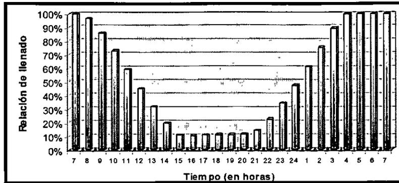
Figura 12.7 Funcionamiento del tanque de regulación de la red ejemplo a lo largo del ciclo.
