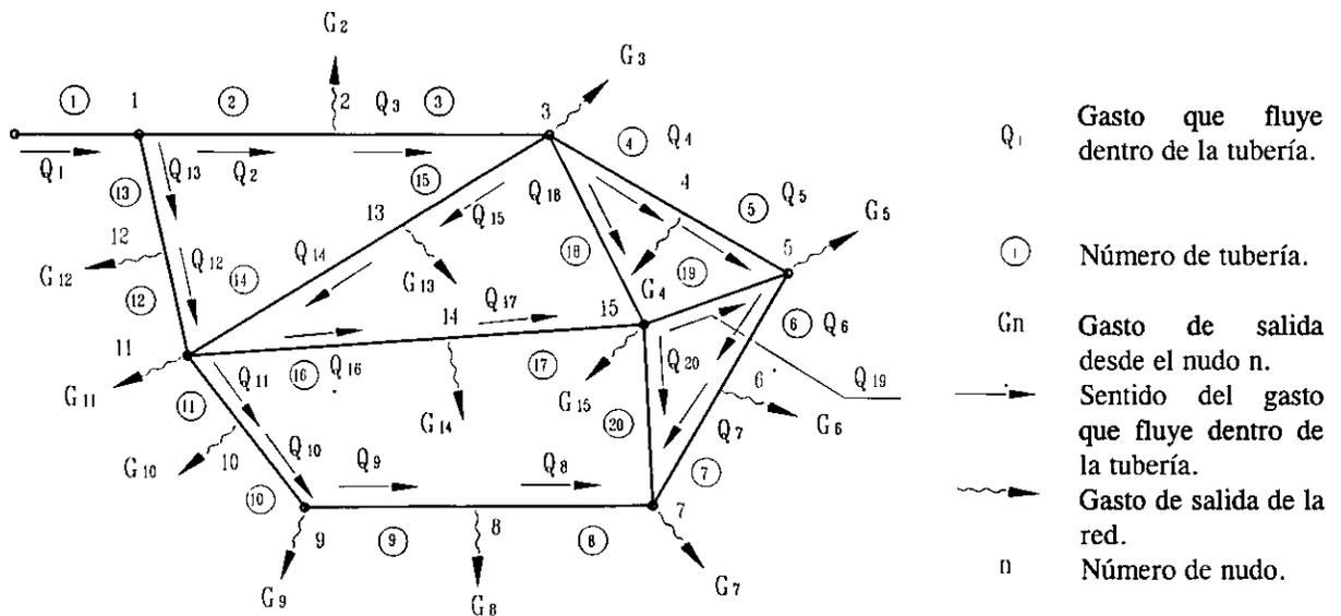
Figura 8.6 Red de tuberías
