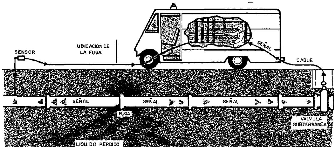
Figura 11.7 Equipo Hidrotronic
