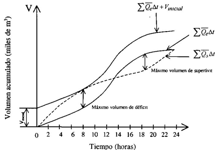
Figura 7.2 Curva masa o diagrama de Rippl
