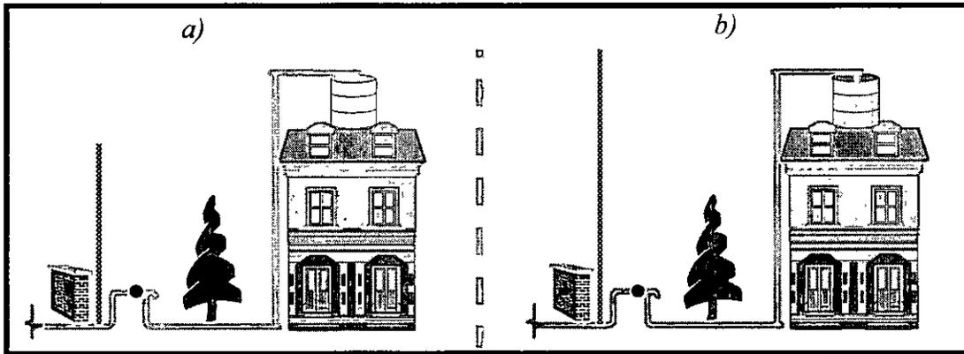
Figura 9.2 Representación esquemática del funcionamiento hidráulico con el método estático modificado. a)  $h < h_{min}$ . b)  $h > h_{min}$
