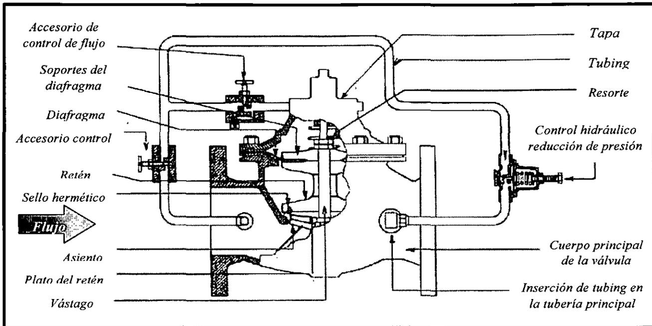
Figura 10.9 Ejemplo de una válvula reductora de presión
