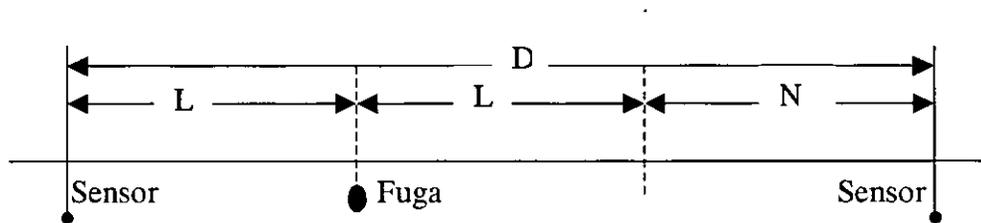
Figura 11.8 Propagación del ruido de una fuga.
