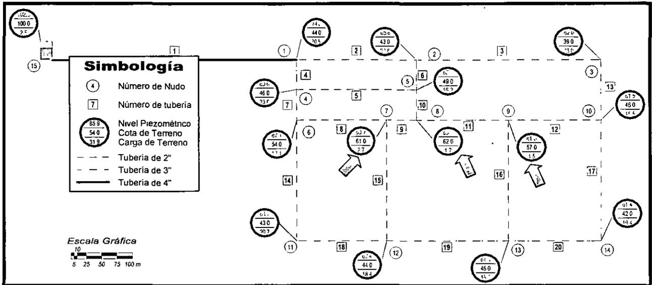
Figura 12.4 Cargas de terreno. Análisis estático modificado
