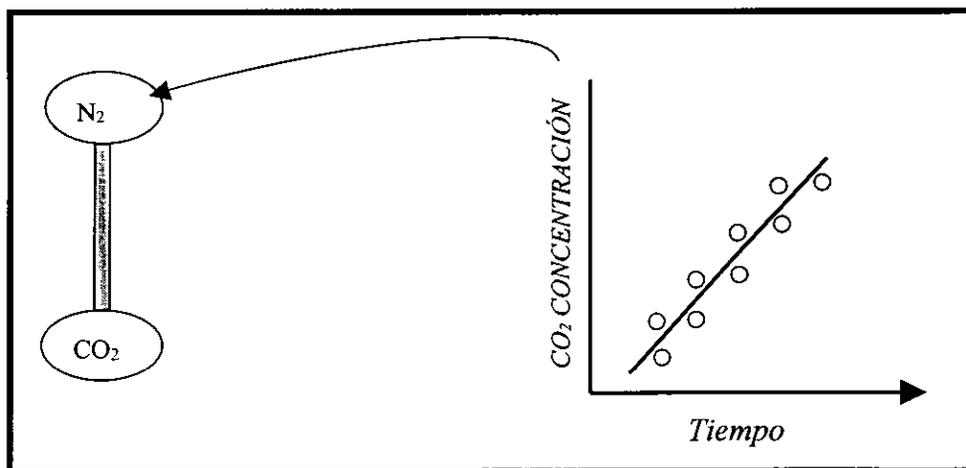
Figura 10.1 Un experimento simple de difusión. Dos bulbos que inicialmente contienen diferentes gases son conectados con un tubo capilar largo. Los cambios de la concentración en cada bulbo son consecuencia de la difusión y pueden ser analizados por dos métodos diferentes.
