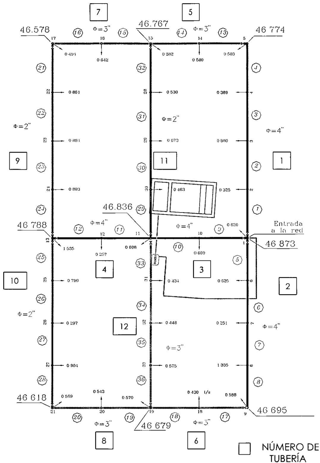
Figura 12.19 Mediciones de laboratorio (Condición sin fuga)
