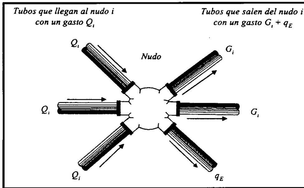
Figura 10.2 Esquema de las tuberías que confluyen en un nudo.
