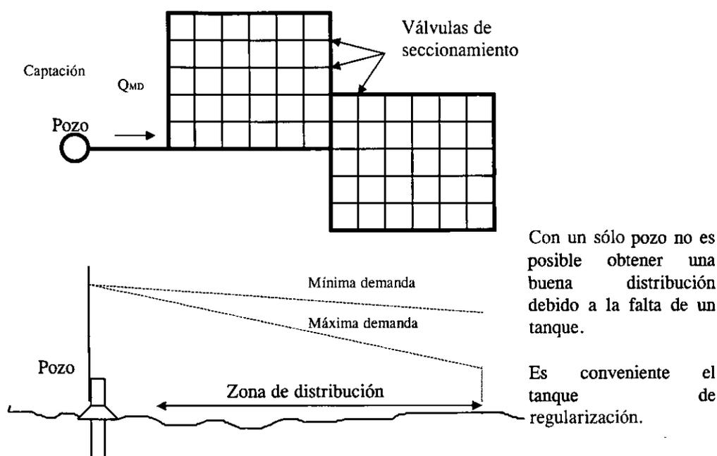
Figura 1.3c Sistema abastecido directamente por bombeo
