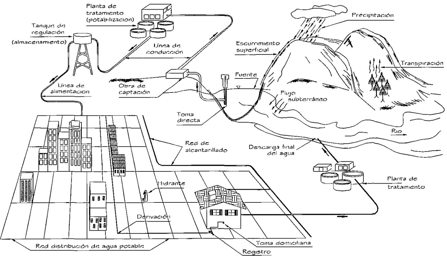
Figura 1.2 Esquema general de un sistema de abastecimiento de agua potable
