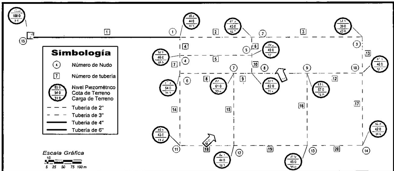
Figura 12.6 Cargas de terreno. Análisis estático modificado con cambios
