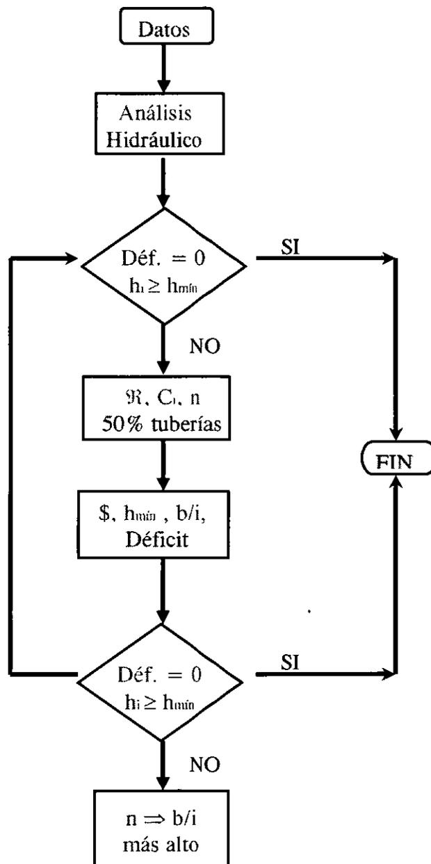
Figura 9.1 Diagrama de flujo para el diseño óptimo
