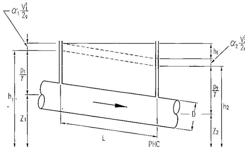
Figura 8.2 Cargas en los extremos de un tubo
