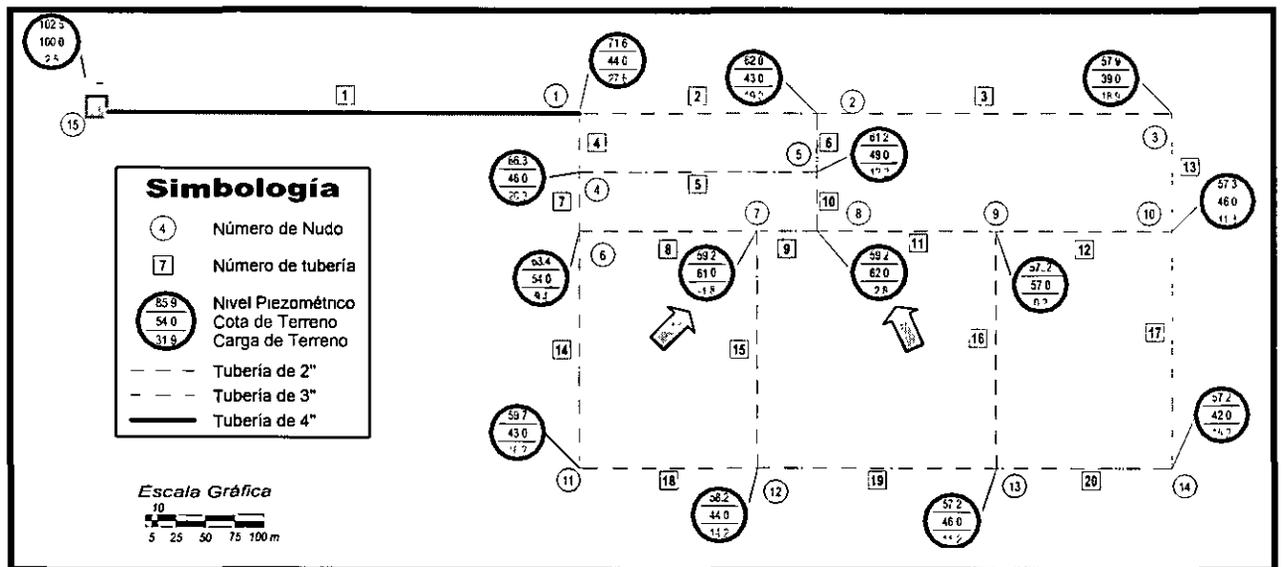
Figura 12.2 Cargas de terreno. Análisis estático tradicional
