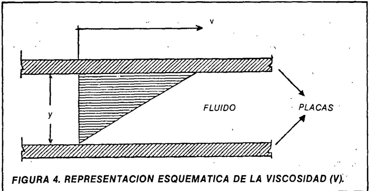
**FIGURA 4. REPRESENTACION ESQUEMATICA DE LA VISCOSIDAD (V).**
