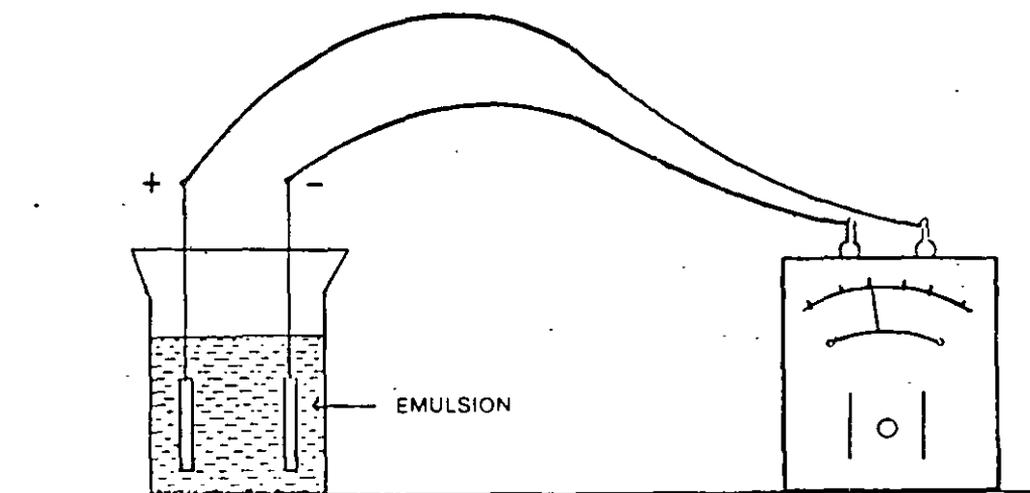
**FIGURA 15. PRUEBA DE CARGA DE LA PARTICULA**
