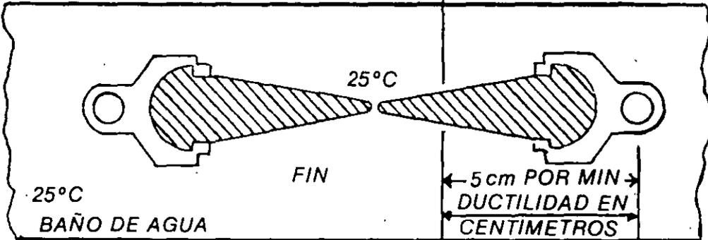
**FIGURA 10. PRUEBA DE DUCTILIDAD**
