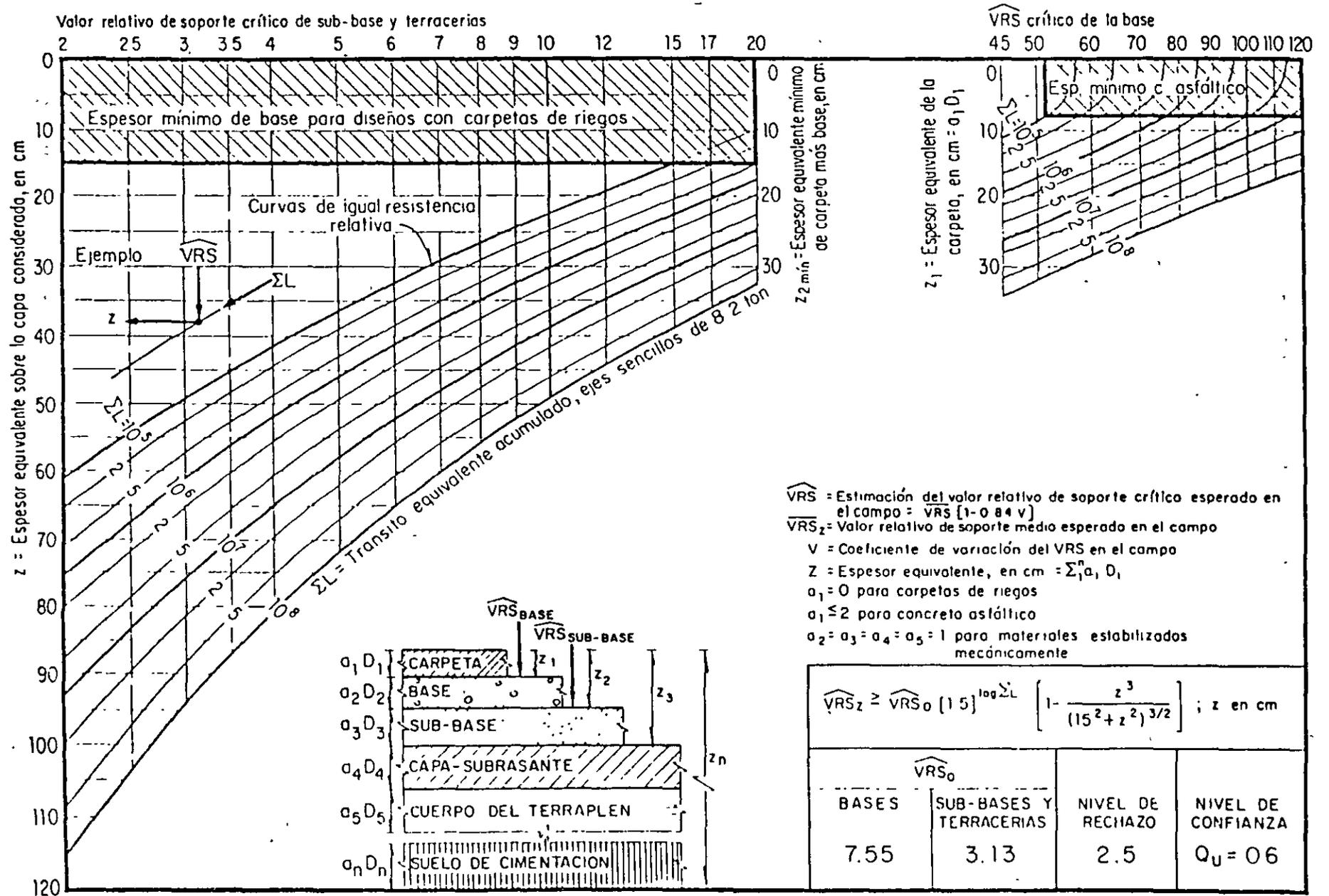
Fig A4. Gráfico para el diseño estructural de carreteras con pavimento flexible
