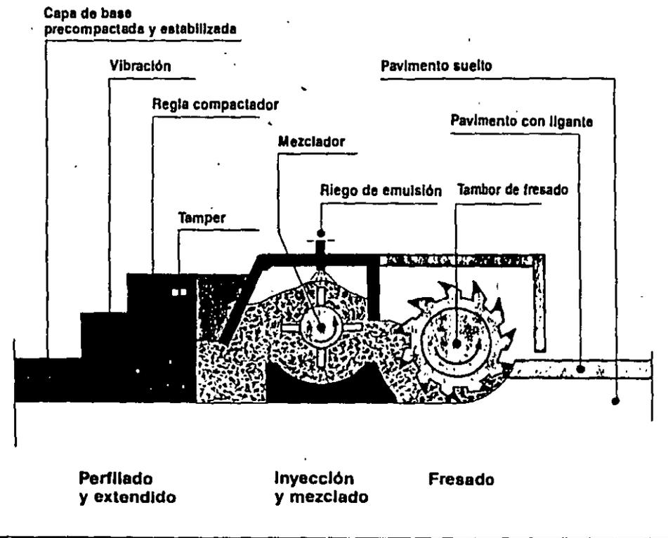
Principios de funcionamiento de la recicladora en frío 1000 CR.
