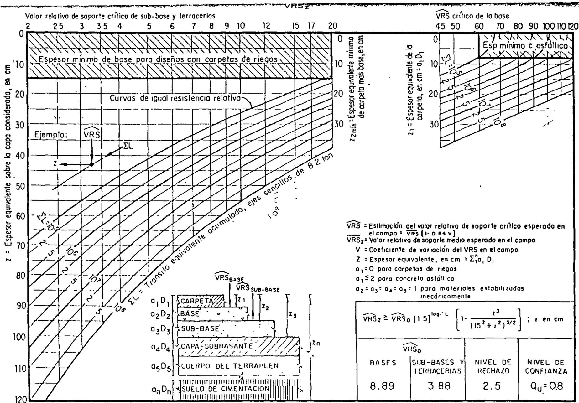
Fig A6. Gráfica para el diseño estructural de carreteras con pavimento flexible
