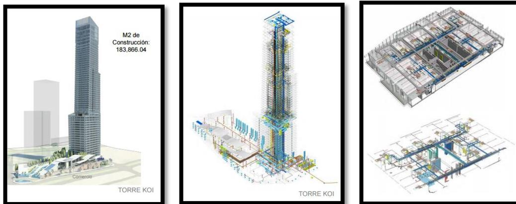
*Imagen 3-6: Modelos BIM de la torre KOI incluyendo modelos de instalaciones*
