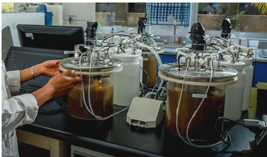
**Figura 3.4 Reactores empleados para el control de fósforo.**
