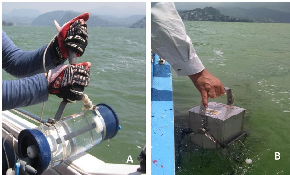
**Figura 3.3 (A) Muestreo de agua con botella van Dorn. (B) Muestreo de sedimento con draga van Veen.**
