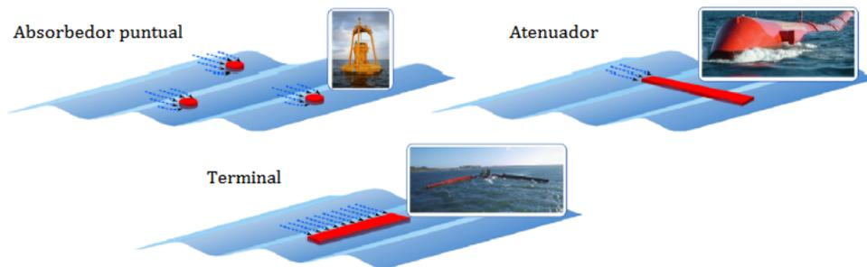
Figura 3.5: Orientación de los WEC. Fuente: [23].
