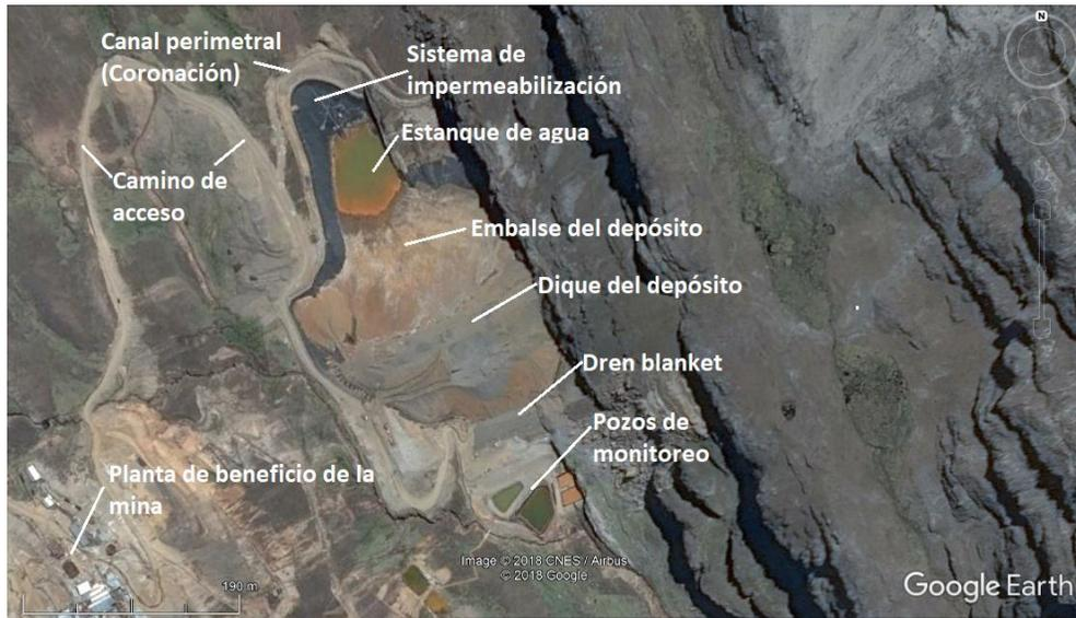
Figura 9.3: Vista satelital del depósito de relaves Oasis y sus componentes (Google Earth, 2018).
