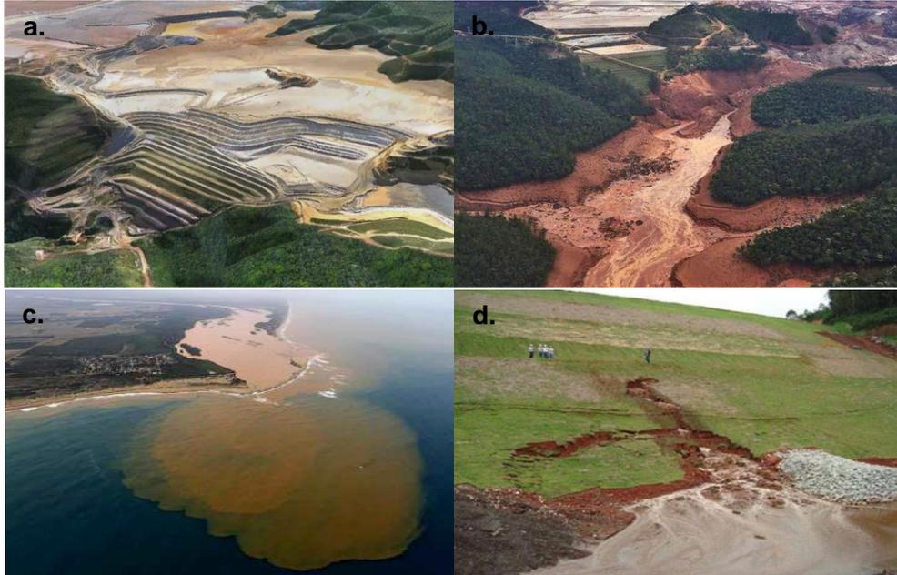
Figura 6.4: Samarco en Brasil en el año 2015, a) ubicación de la zona que presentó licuación estática b) vista área de la falla del depósito, c) relaves que alcanzaron el océano atlántico, y d) erosión sobre el dique de arranque (Jonsson y Ljunggren, 2010; Morgenstern, Vick, Watts y Viotti, 2016; Van Zyl, 2017).
