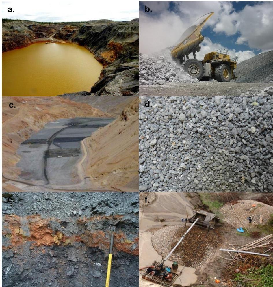
Figura 2.10: a) Mina con problemas de acidez. b) vertedero de rocas de desecho de mina, c) depósito de relaves, d) escorias, e) residuos de lixiviación en pilas, y f) residuos de placeres (Lottermoser, 2010, Oyarzun, Higuera y Lillo, 2011, MINAM PERU, 2011, STEINERT, 2017).
