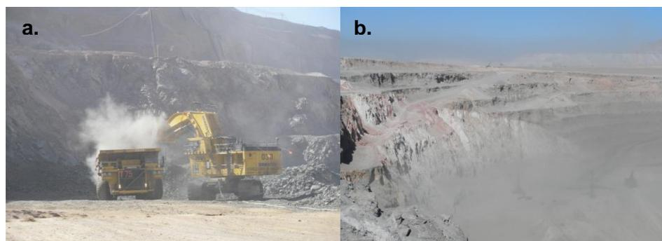
Figura 2.11: a). Generación de polvo por trabajos con maquinaria y b) generación de polvo por la presencia de fuertes vientos (Oyarzun, Higuera y Lillo, 2010)
