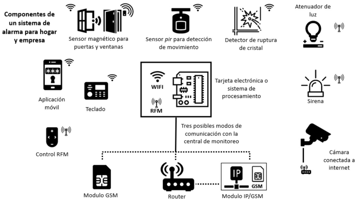
Imagen 3.3. Sistema de alarma común.
