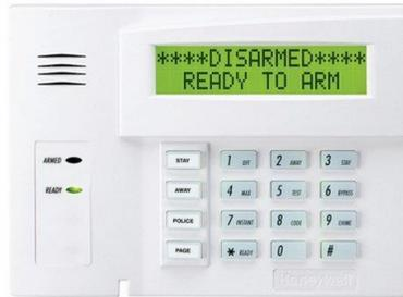
Imagen 3.7. Teclado alfanumérico para alarma de la marca Honeywell®
