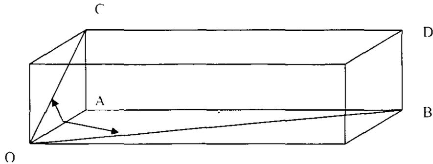
Para este caso, el punto O es el punto base para la medición, la distancia horizontal se refiere a las mediciones hechas de los puntos OA y OB y el ángulo vertical OAC. La distancia inclinada se representa como OC ya que siempre se determina según el plano inclinado con respecto a la horizontal.
