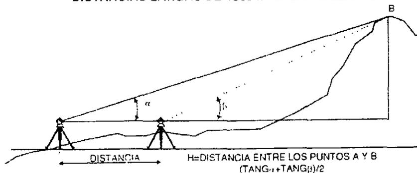
La nivelación trigonométrica se usa en los trabajos topográficos de configuración en terrenos muy escabrosos o accidentados. En visuales de gran longitud, los errores debidos a la curvatura terrestre y la refracción son significativos, pero se eliminan aplicando las correcciones específicas.
