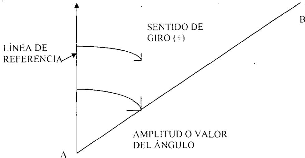
En topografía los ángulos se clasifican en horizontales y verticales. Los ángulos horizontales son las medidas básicas que se necesitan para determinar rumbos y acimutes
