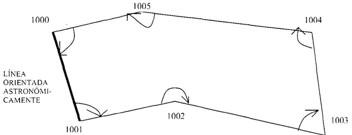
Según el dibujo la línea 1000 - 1001 está orientada astronómicamente por procedimientos topográficos o geodésicos para determinar la latitud y longitud deduciendo el acimut astronómico.
