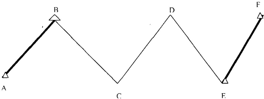
Según la figura las líneas (A - B y E - F) están orientadas astronómicamente por procedimientos topográficos o geodésicos, de los cuales se obtuvieron las coordenadas para después realizar el comparativo de ambas coordenadas quedando así geoméricamente abierta y analíticamente cerrada.
