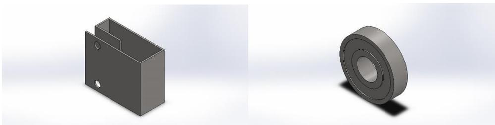
*Fig. 4.11. Sustitución de deslizaderas por rodamientos.*
