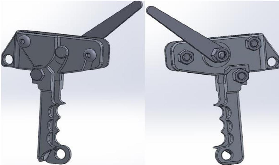
Figura 4.2 Modelo CAD 3D del sistema de bloqueo de cuerdas
