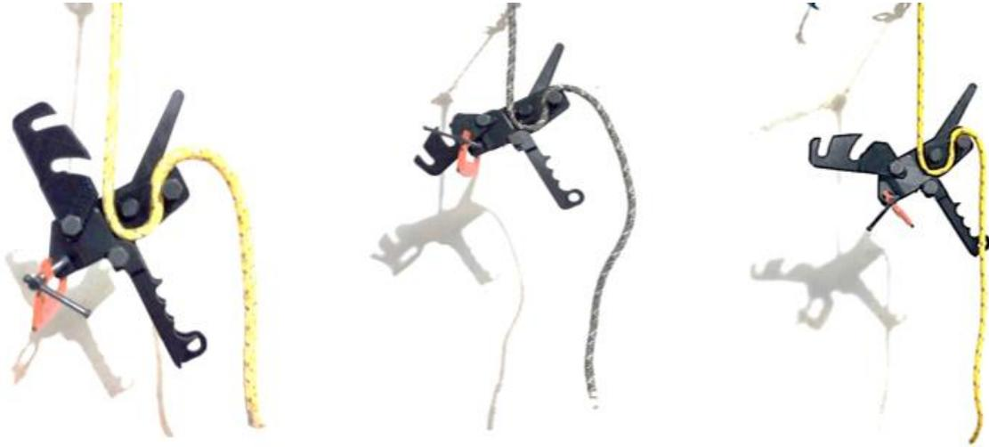
Figura 5.11 Prueba 2 de funcionamiento en posición de descenso
