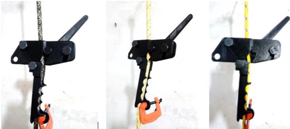
Figura 5.4 Pruebas de bloqueo en posición de ascenso
