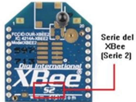
Figura 2. XBee S2.
