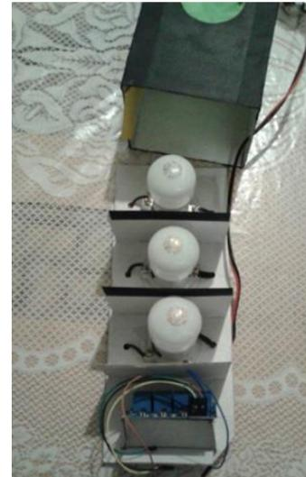
Figura 6. Conexiones del circuito a los relevadores.
