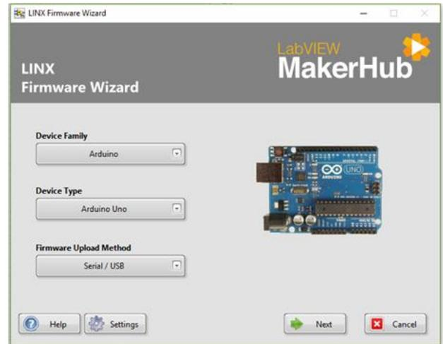
Figura 12. Ajustes para la comunicación con el Arduino.
