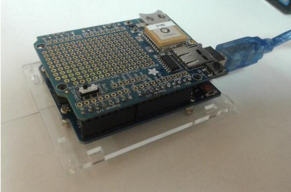
Figura 2. GPS montado sobre Arduino.
