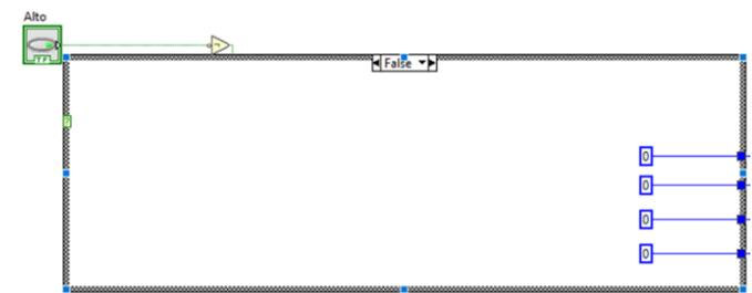
Figura 24. Caso FALSE para detener el motor.
