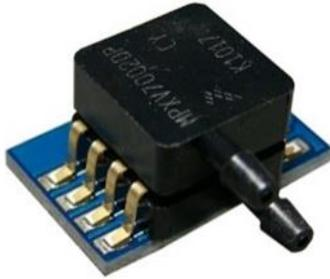
Figura 3. Sensor de presión MPXV7002.
