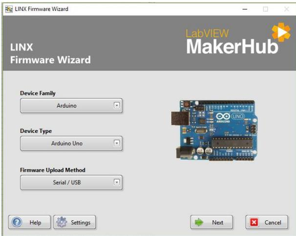
Figura 10. Ajustes para la comunicación con el Arduino
