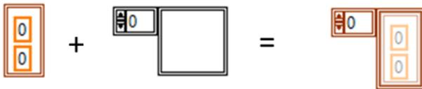
Figura 12. Elementos para construir el arreglo de clusters.
