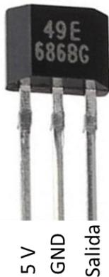
Figura 3. Terminales del sensor de efecto Hall A3144.
