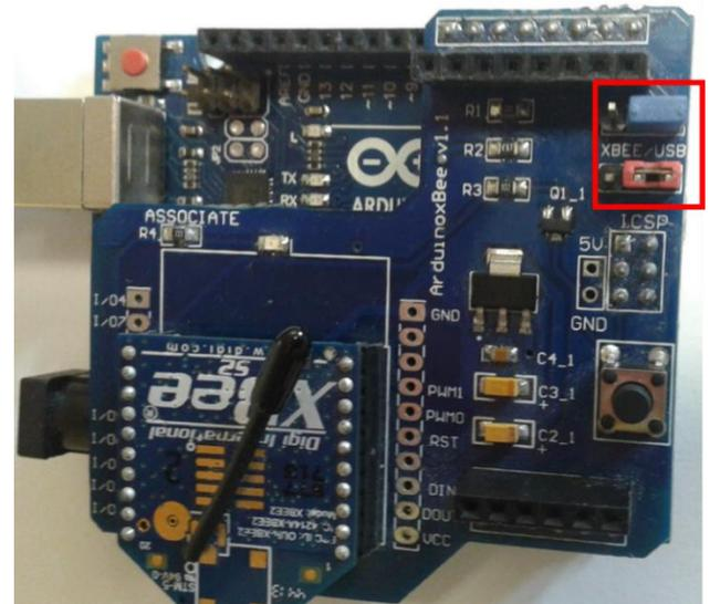
Figura 7. Terminales-headers en modo USB.
