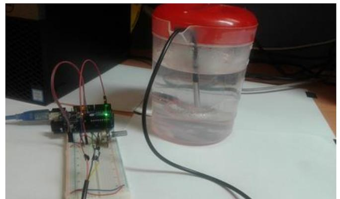
Figura 1. Montaje del sensor dentro de un recipiente. El recipiente mostrado tiene integrado una resistencia, la cual al conectarse a la red eléctrica incrementa la temperatura del líquido generando burbujas en el interior.
