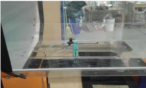
Figura 17. Tubo de Pitot sujeto al soporte.
