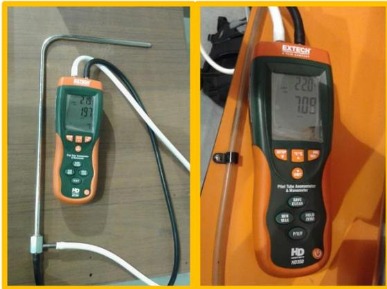
Figura 6. Anemómetro usado para calibrar el tubo de Pitot.
