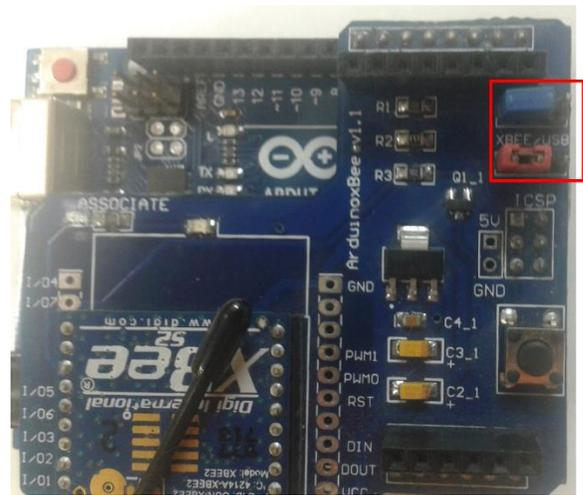
Figura 26. Terminales-headers en modo XBee.
