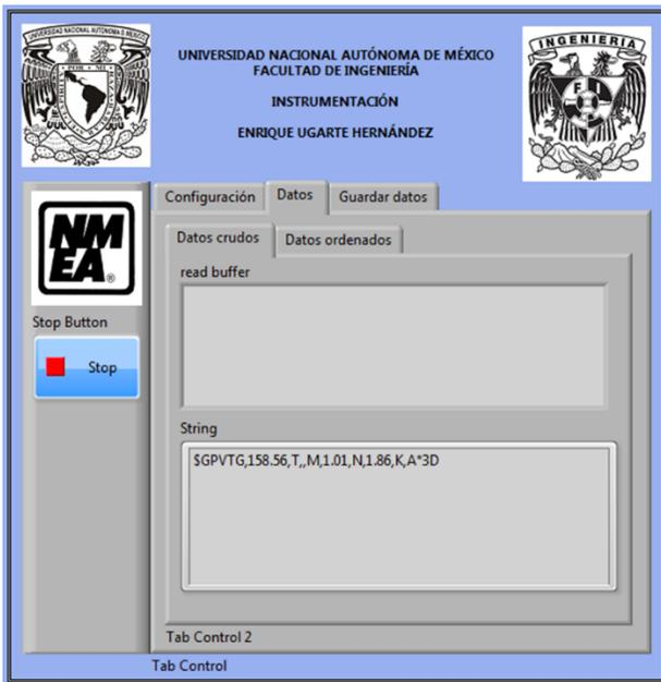
Figura 8. Datos crudos del GPS. Segunda página del contenedor con pestañas principal.
