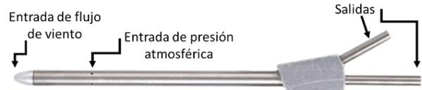
Figura 1. Tubo de Pitot para Ardupilot.
