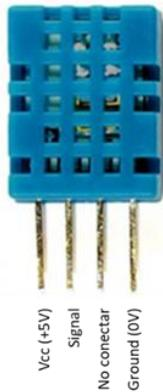
Figura 3. Sensor DHT11 solo.
