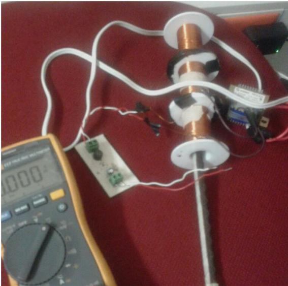
Figura 15. Ejemplo de LVDT con excitación de transformador.
