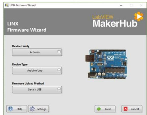
Figura 9. Ajustes para la comunicación con el Arduino.
