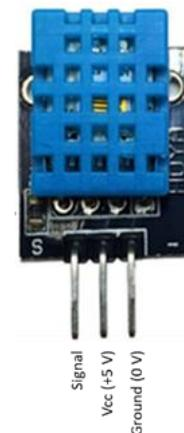
Figura 1. Sensor DHT11 montado en placa.
