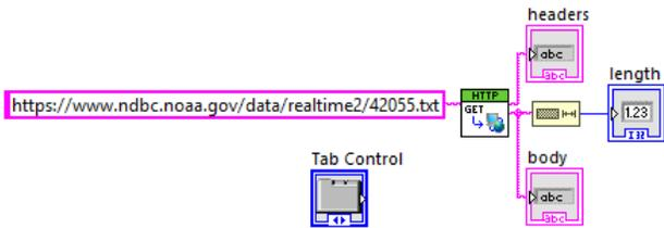
Figura 9. Diagrama de bloques para obtener los datos crudos.
