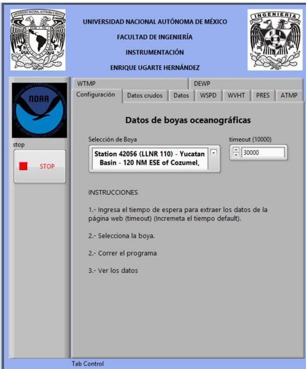
Figura 21. Pestaña de la selección de la boya. Nótese que el control para el tiempo de espera del bloque GET marca 30 segundos.
