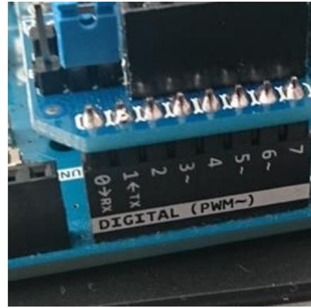
Figura 25. Puerto serie 0 en la tarjeta Arduino DUE.
