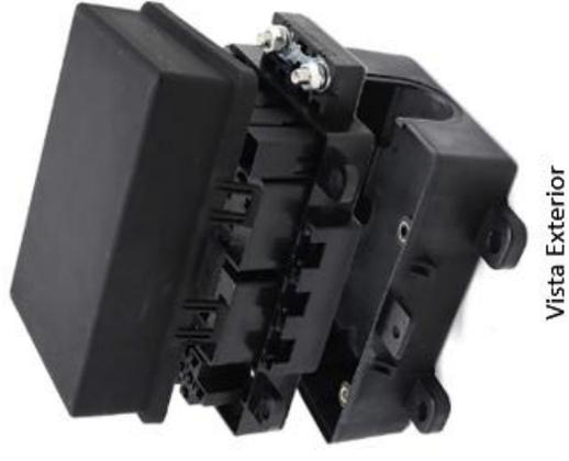
Fig. Caja de fusibles automotriz
