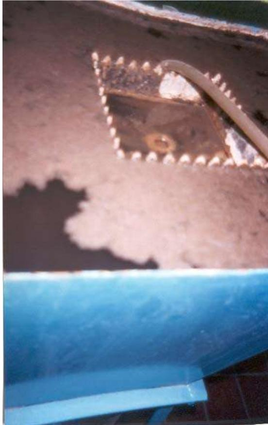
Figura 30. Nata de la superficie del clarificador secundario de la planta piloto.
