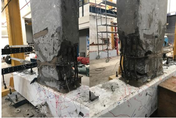
**a) Conexión viga-columna dañada, primera prueba, CENAPRED**
