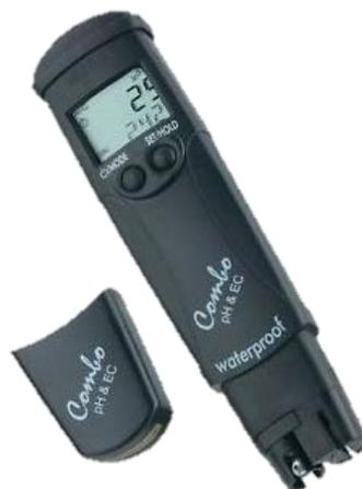
Figura 5.7 Multiparamétrico portátil
