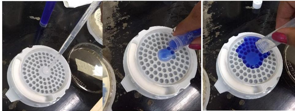
FIGURA 5.4 Procedimiento de mezcla de muestra con medio de cultivo
