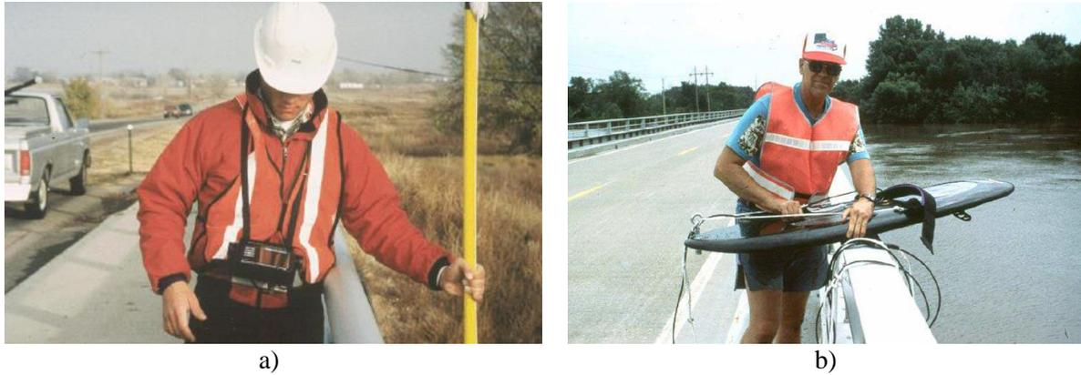
Figura 7.48. Ecosondas o fatómetros portables instalados en: (a) una barra y; (b) tabla de surf.
