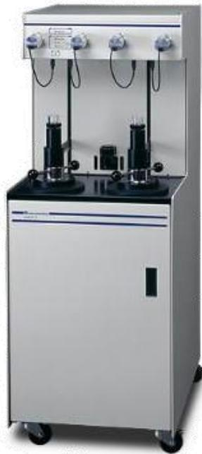
***Figura 2.2 Porosímetro de alta presión.***
