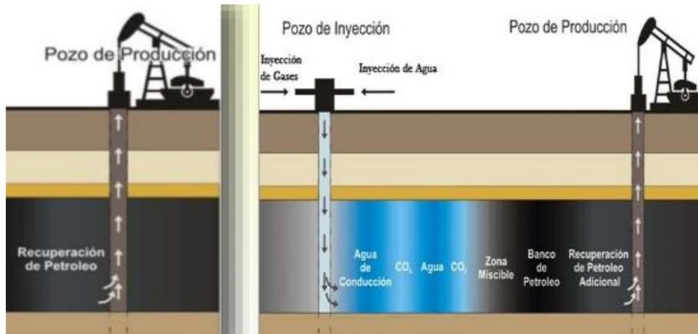
**Figura 6. Diferencia entre los tipos de recuperación. Del lado izquierdo se muestra la recuperación primaria en donde el hidrocarburo fluye solo mediante la presión del yacimiento, del lado derecho se muestra la recuperación secundaria donde se observa un pozo productor y uno inyector esto debido a que ya se necesita de algún fluido de empuje para poder producir.**
