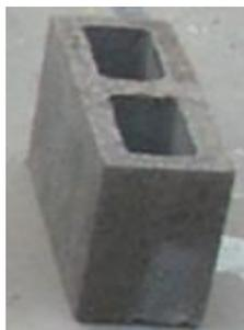
Foto 5: Bloque hueco de concreto, Fuente: SMIE
