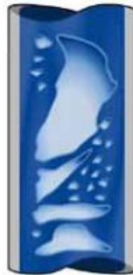
Fig. 1.8 Sección de tubería vertical con flujo tipo churn [2].
