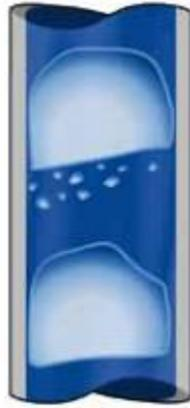
Fig. 1.7 Sección de tubería vertical con flujo tipo slug [2].
