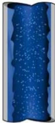
Fig. 1.9 Sección de tubería vertical con flujo tipo anular [2].
