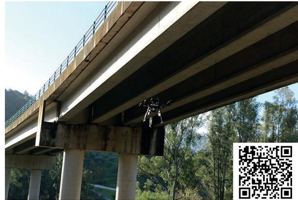
Ilustración 25. Dron articulado con sensores y cámaras para evaluación de puentes © Proyecto AEROBI 2018
