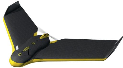
Ilustración 22. Dron Ligero - ebee © Sensefly.
