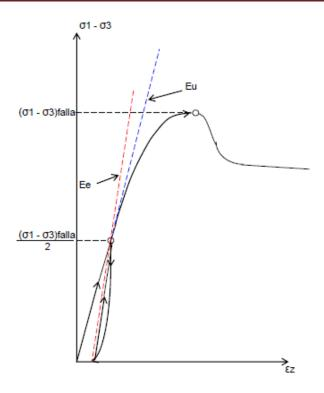
Grafica 4.1. Ejemplo ilustrativo de prueba de carga descarga
