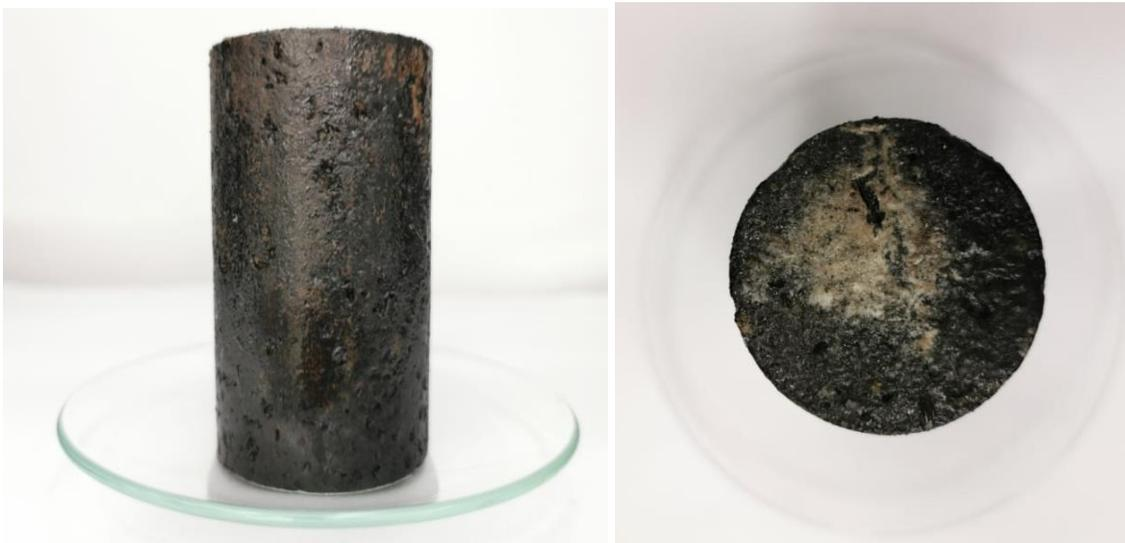
*Figura 5.15: Condiciones del tapón después de la imbibición capilar con agua de formación sintética y tensoactivo.*
