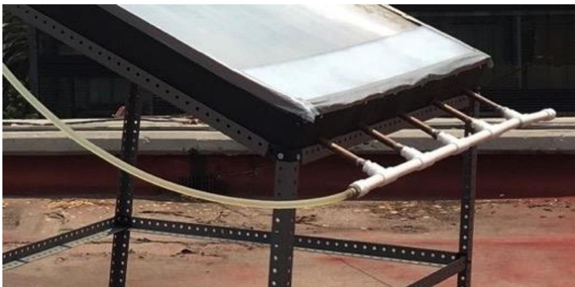
**Figura 3.12: Conexión Manguera de 1/2" a cabezal de 1/2".**
