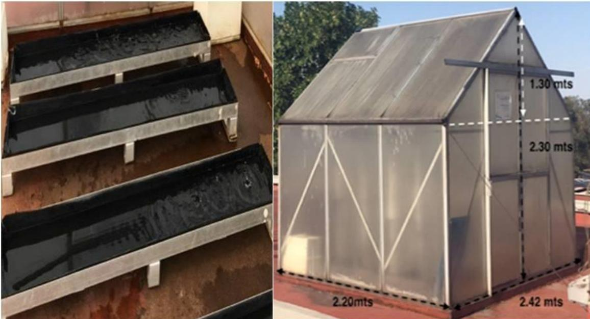
Figura 3.1: Bandejas de aluminio (izquierda) y caseta tipo invernadero (derecha).
