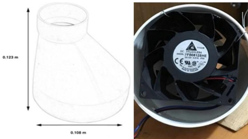
Figura 3.18: Codo con reducción para extractor (Elaboración propia, 2017).
