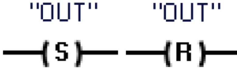
Figura 3.4 - Activar salida (izquierda) y desactivar salida (derecha) en TIA Portal
