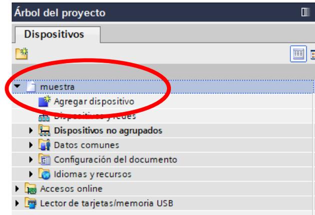
Figura 2.5 - Tarea del portal Dispositivos y redes para añadir un CPU
