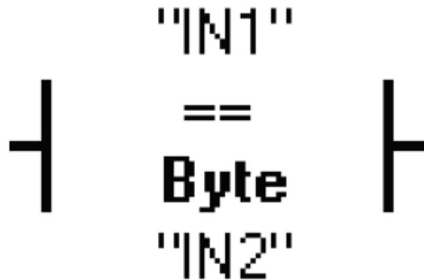
*Figura 3.33 - Contacto de comparación (igualdad) en TIA Portal. Se especifica que se van a comparar datos del tipo Byte. El parámetro superior es el primer argumento; y el inferior, es el segundo argumento*
