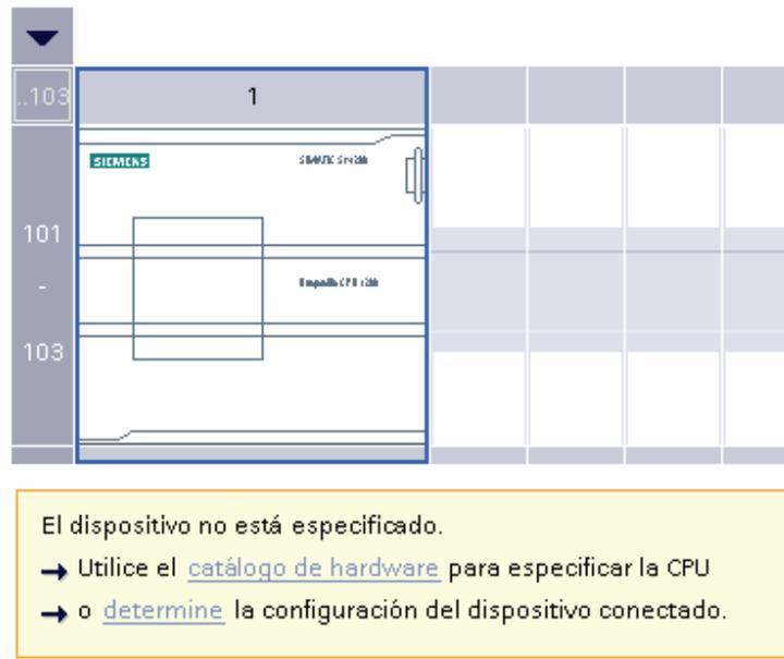
Figura 2.10 - CPU sin especificar en el área de trabajo
