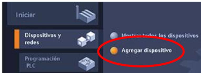
Figura 2.4 - Tarea del portal *Dispositivos y redes* para añadir un CPU
