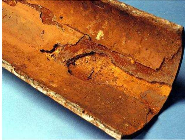
Figura 2.2: Corrosión interna en un oleoducto [7].
