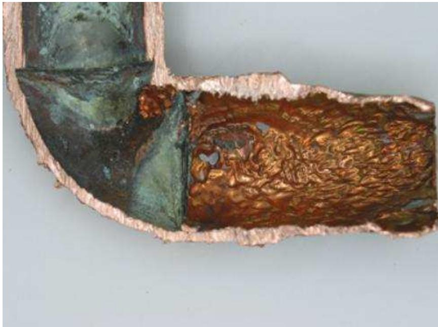
Figura 2.5: Corrosión por Erosión [23].
