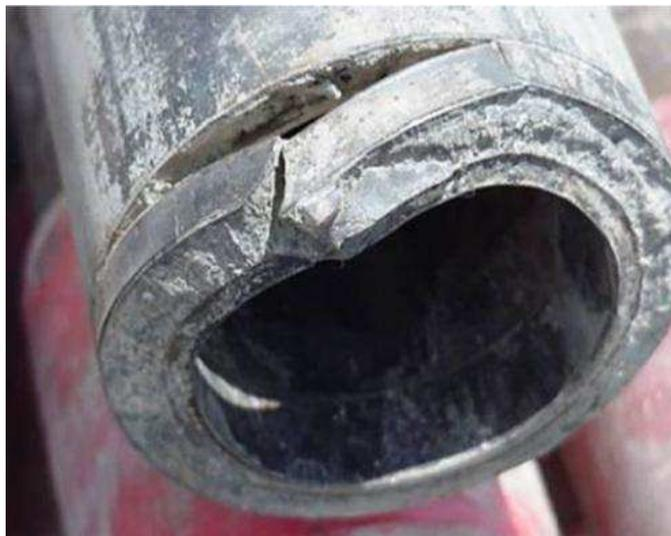
Figura 2.3: Oleoducto con corrosión por  $H_2S$  [7].
