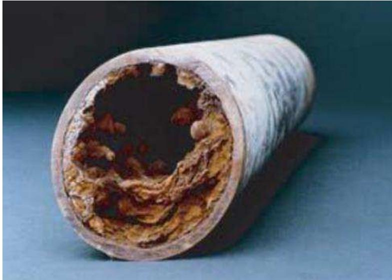
Figura 2.7: Tubería afectada por Corrosión microbacteriana [7].
