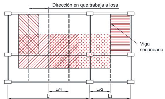
Sistema de piso con vigas principales, vigas secundarias y losa en una sola dirección (vigueta-bovedilla)
