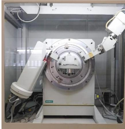
Figura 11. Difractómetro de Rayos X marca Siemens modelo D5000. Instituto de Geología UNAM.
