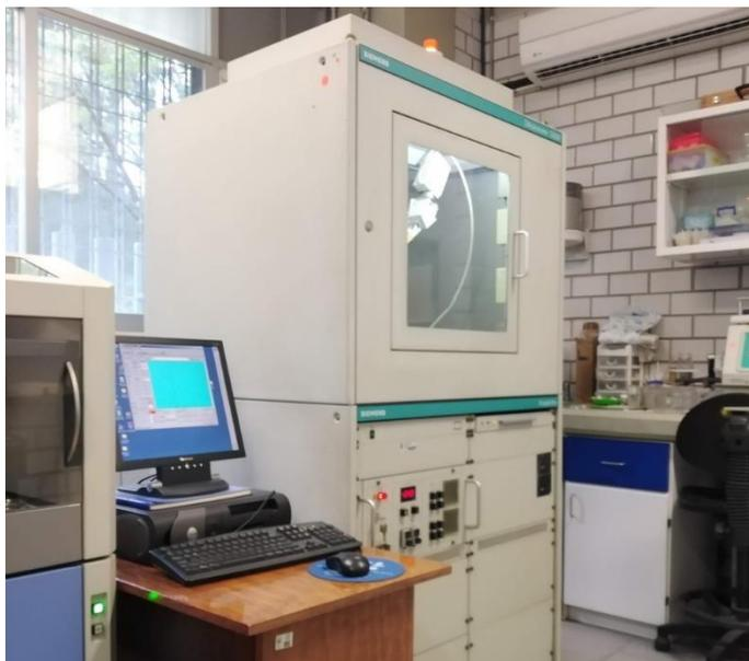
Figura 13. Difractómetro marca Siemens modelo D5000. Instituto de Geología, UNAM.
