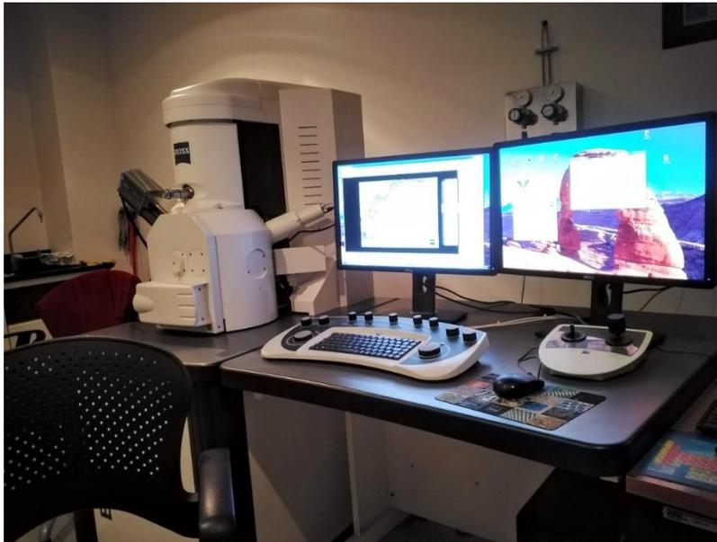
Figura 8. Microscopio Electrónico de Barrido Zeiss EVO|MA10 con un detector/analizador Bruker SFlash6|10 y un detector NTS BSD, con un voltaje de 15.00 Kv. Instituto de Geología UNAM.
