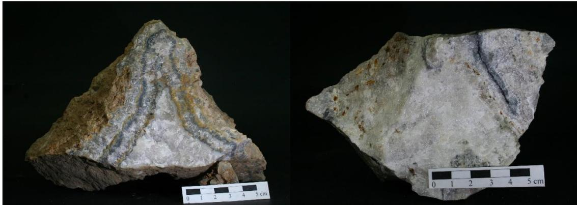
Figura 23. Muestras de veta de cuarzo con textura crustiforme (izq) y coliforme (der) con bandas de galena y acantita.
