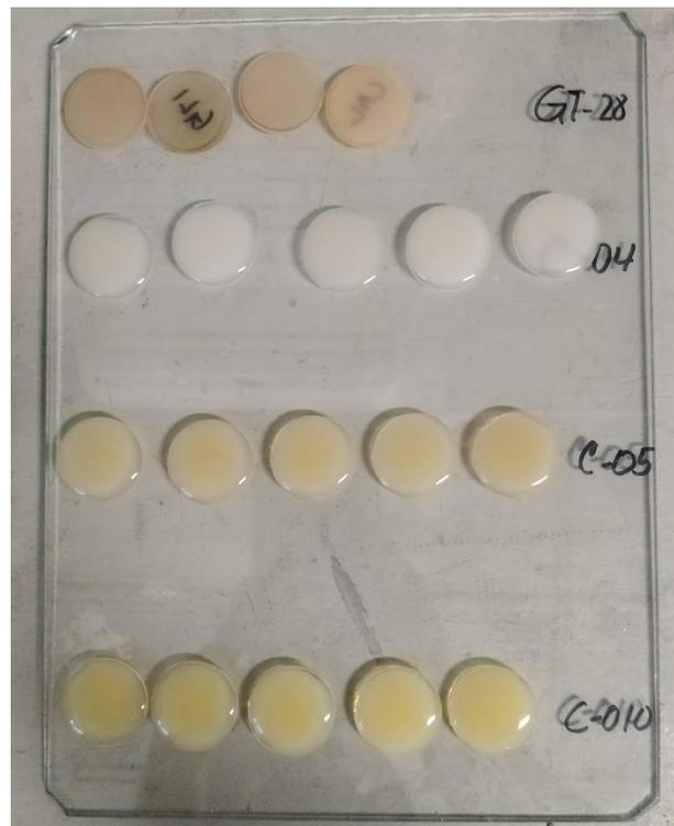
Figura 12. Muestras para el análisis de arcillas en la parte fina.
