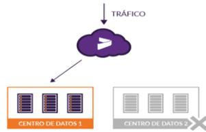
**Figura 3-16 Conmutación automática por error de sitio**
