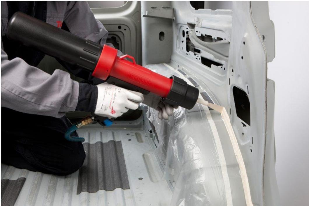
**Figura 12. Aplicación de sello en las uniones de lámina**
