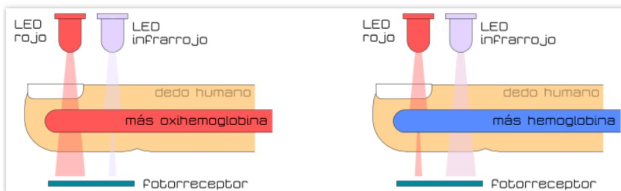
Figura 38 Esquema del sensor de oxigenación de la sangre [49]
