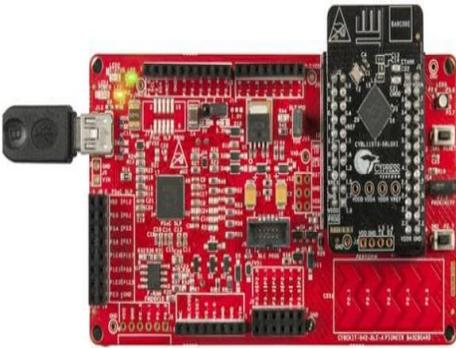
En la figura 20 se muestra la tarjeta de desarrollo CY8CKIT-042-BLE-A, esta tarjeta está diseñada para soportar redes mesh y sistemas compatibles con IoT, la tarjeta cuenta con las siguientes especificaciones técnicas:
