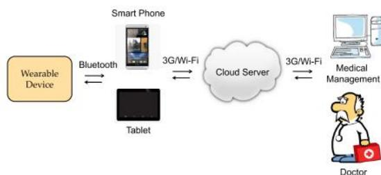
Figura 12 Diagrama de bloques del sistema [20]
