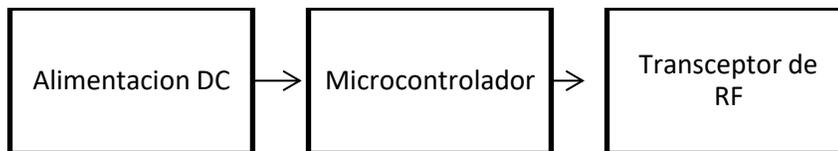
*Figura 107 Estructura a nivel hardware del servidor local*
