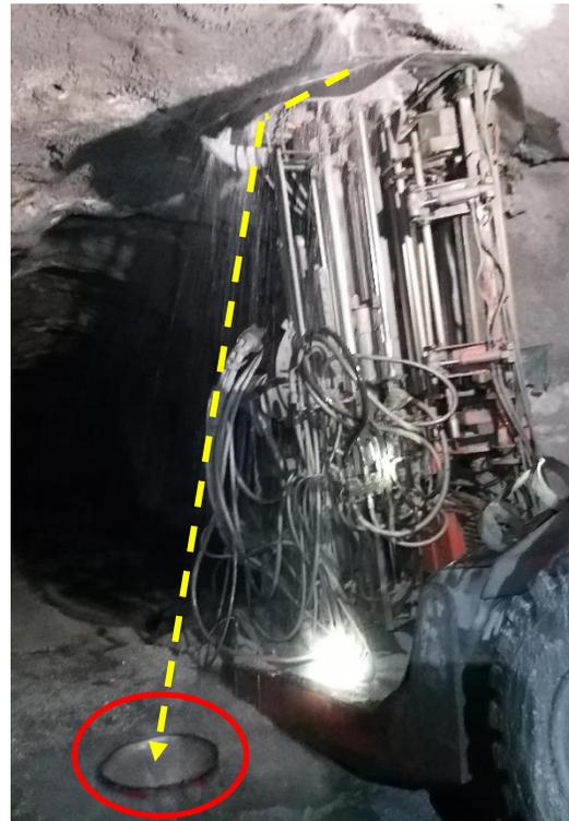
Figura 38. Recipiente colocado al módulo de perforación a 80°
