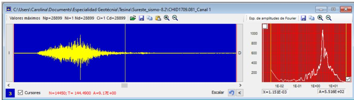
*Fig. 4.17. Cálculo del espectro de Fourier con el software DEGTRA para el archivo del sismo CHID1709.081*
