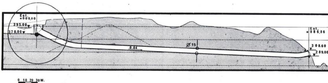
Fig. 3.20. Perfil del vertedor tipo túnel, presa Chicoasén, (Tomada de Ramírez, S., 2011).
