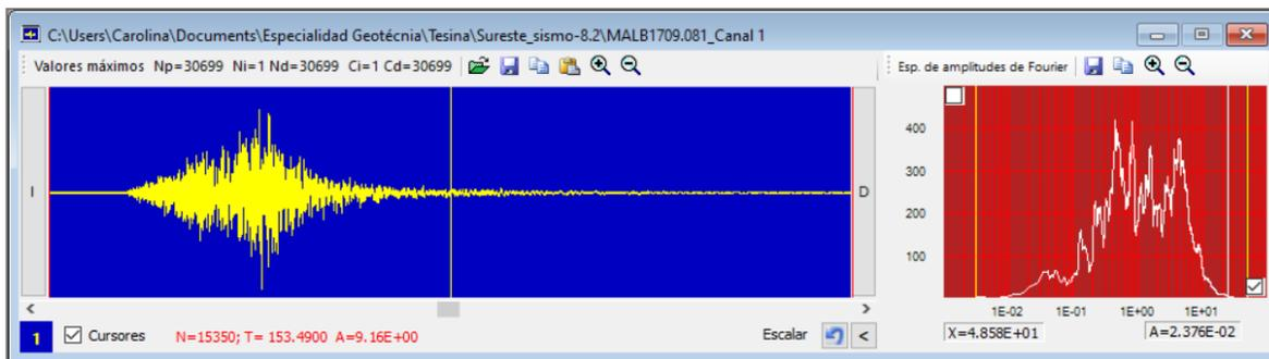
Fig. 4.3. Cálculo del espectro de Fourier con el software DEGTRA para el archivo del sismo MALB1709.081
