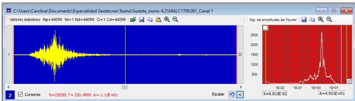
*Fig. 4.5. Cálculo del espectro de Fourier con el software DEGTRA para el archivo del sismo MALC1709.081*
