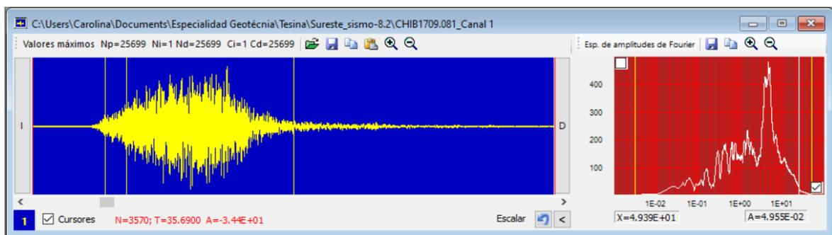
Fig. 4.13. Cálculo del espectro de Fourier con el software DEGTRA para el archivo del sismo CHIB1709.081
