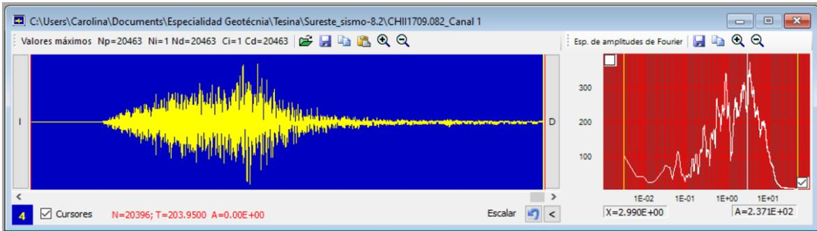
Fig. 4.18. Cálculo del espectro de Fourier con el software DEGTRA para el archivo del sismo CHII1709.081
