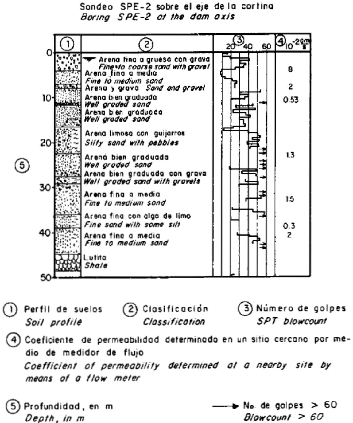
Fig. 3.34. Perfil de suelos típicos del aluvión, resistencia a la penetración estándar y resultados de pruebas de permeabilidad, (Tomada de Comportamiento de presas construidas en México, 1985).
