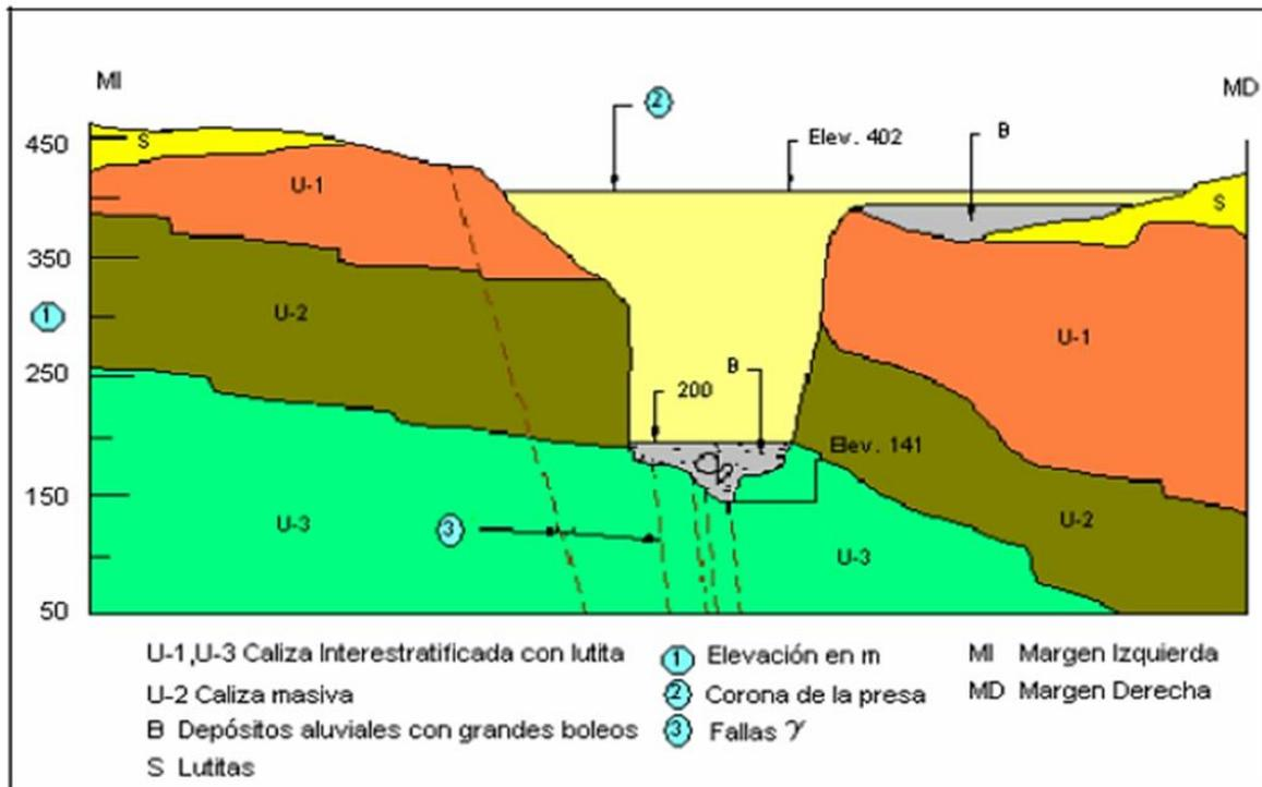
Fig. 3.22. Perfil geológico a lo largo del eje de la presa Chicoasén (Tomada de García, G., 2016).
