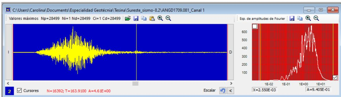
*Fig. 4.9. Cálculo del espectro de Fourier con el software DEGTRA para el archivo del sismo ANGD1709.081*
