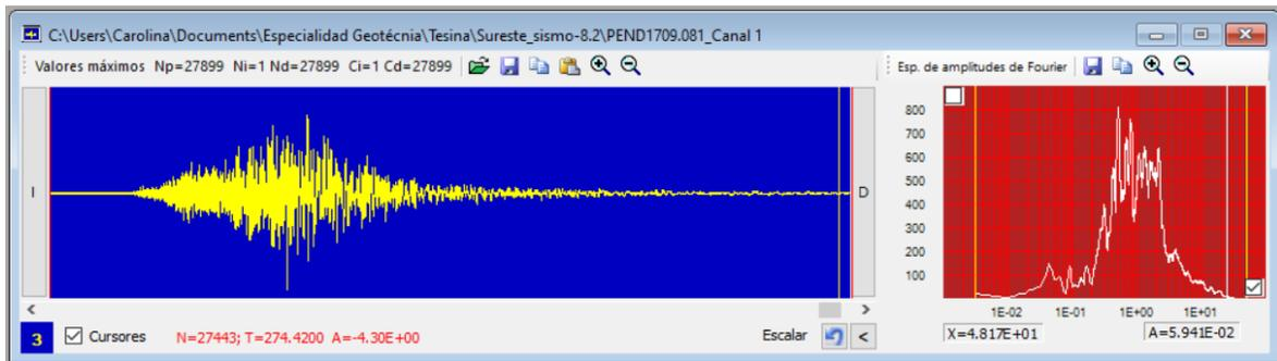
*Fig. 4.25. Cálculo del espectro de Fourier con el software DEGTRA para el archivo del sismo PEND1709.081*
