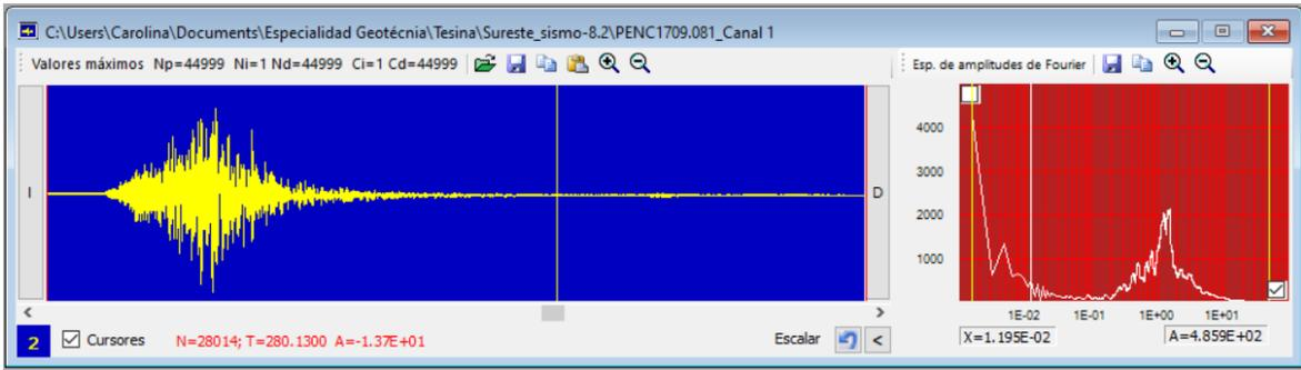
Fig. 4.23. Cálculo del espectro de Fourier con el software DEGTRA para el archivo del sismo PENC1709.081
