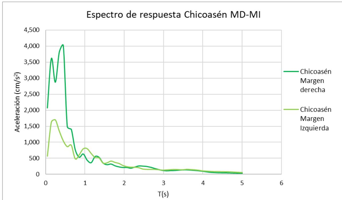
Fig. 4.32. Espectro de respuesta de la margen derecha y margen izquierda de la presa Chicoasén.
