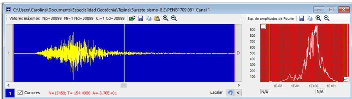
Fig. 4.21. Cálculo del espectro de Fourier con el software DEGTRA para el archivo del sismo PENB1709.081
