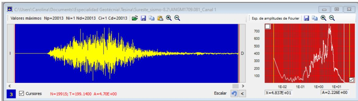
Fig. 4.11. Cálculo del espectro de Fourier con el software DEGTRA para el archivo del sismo ANGM1709.081
