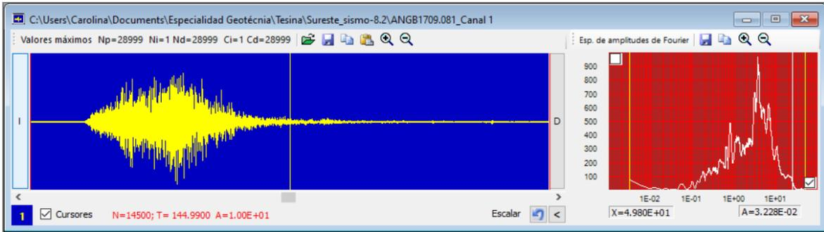
Fig. 4.7. Cálculo del espectro de Fourier con el software DEGTRA para el archivo del sismo ANGB1709.081
