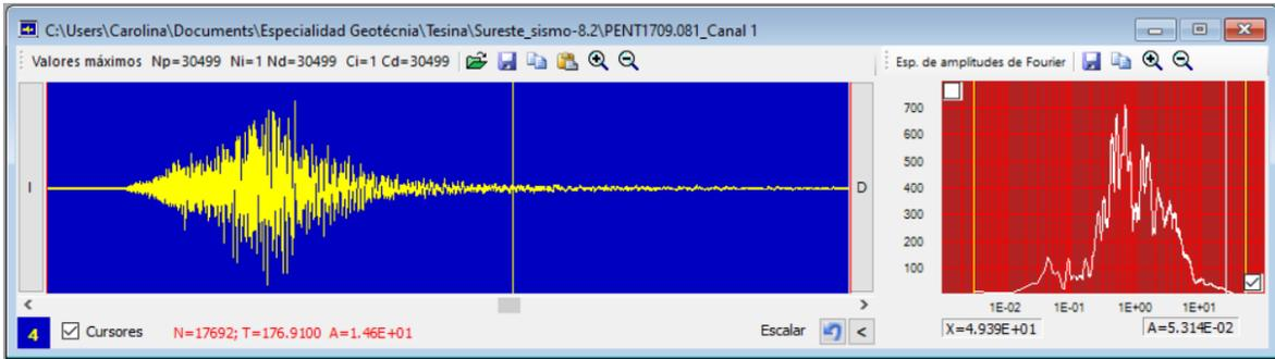
Fig. 4.27. Cálculo del espectro de Fourier con el software DEGTRA para el archivo del sismo PENT1709.081
