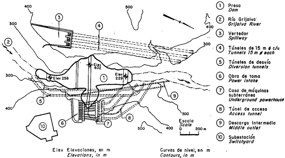
Fig. 3.18. Vista en planta de la presa Chicoasén (Tomada de CFE, SRH & UNAM., 1976).
