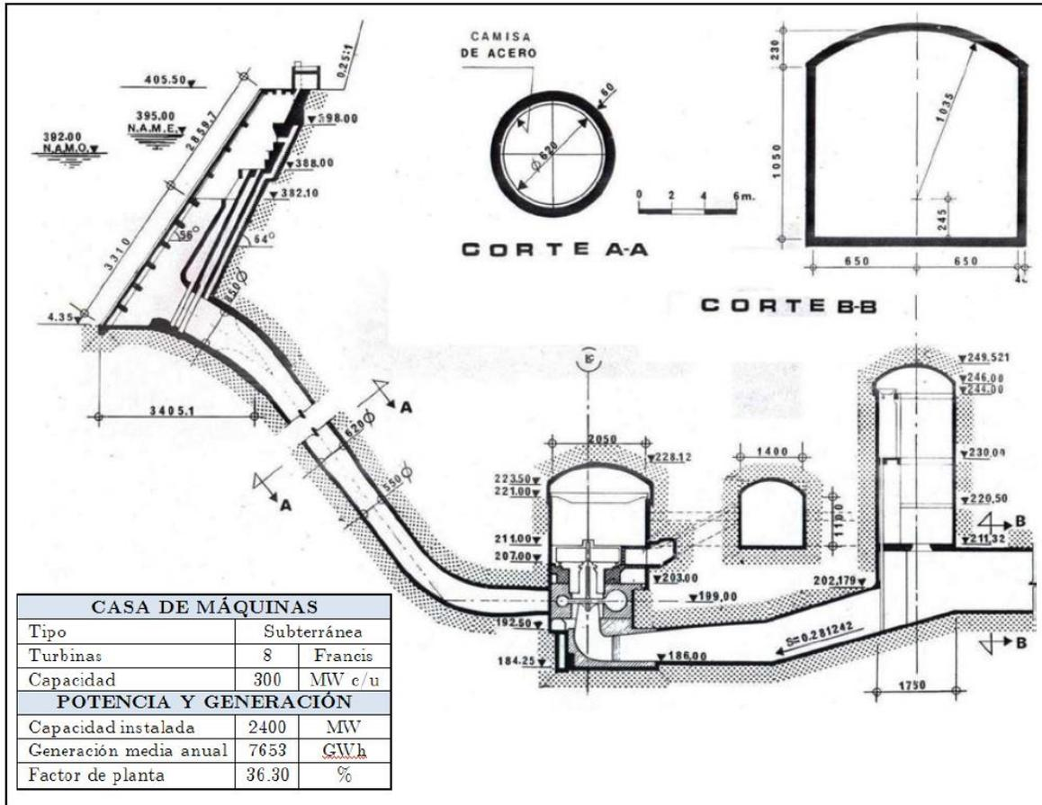
Fig. 3.21. Planta hidroeléctrica, presa Chicoasén, (Tomada de Ramírez, S., 2011).
