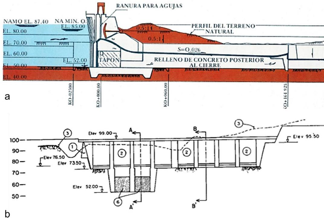
Fig.3.30. Vertedor de la Presa Peñitas: a) Vista de perfil del vertedor, b) Vista del vertedor desde aguas arriba, (Tomada de Ramírez, S., 2011; CFE, 1985).
