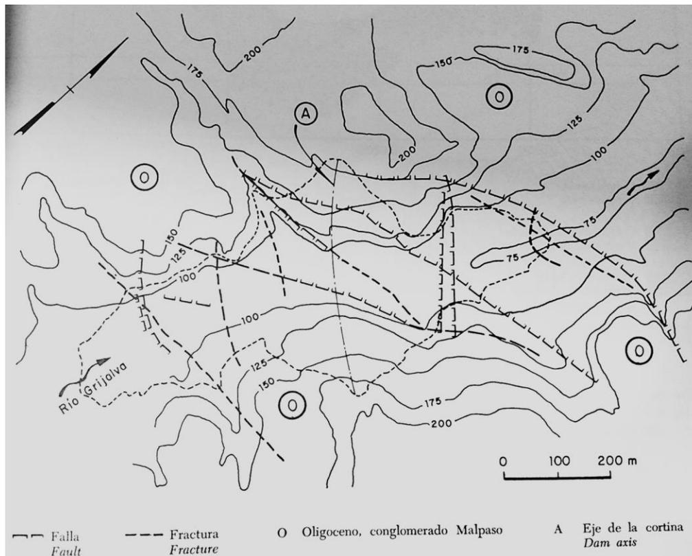
Fig. 3.6. Geología del sitio Malpaso, (Comportamiento de presas construidas en México, 1976).
