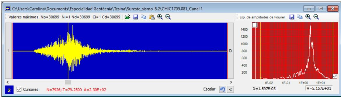
Fig. 4.15. Cálculo del espectro de Fourier con el software DEGTRA para el archivo del sismo CHIC1709.081
