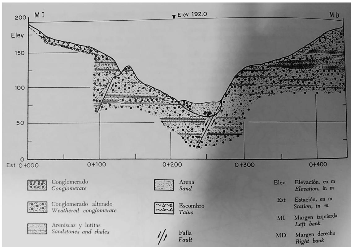
Fig. 3.7. Corte geológico según el eje de la cortina, (Comportamiento de presas construidas en México, 1976).
