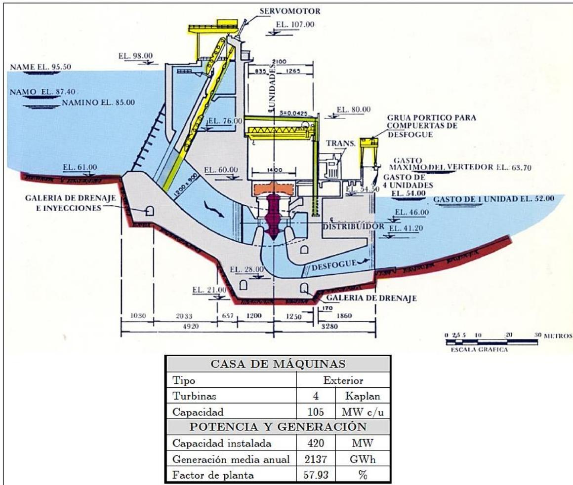
Fig.3.31. Planta hidroeléctrica de la presa Peñitas (Tomada de Ramírez, S., 2011).
