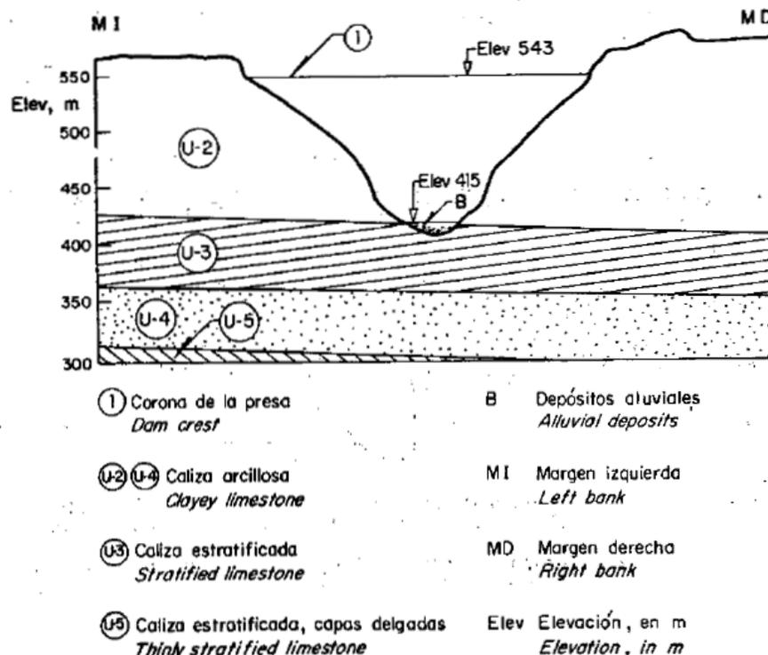
Fig. 3.13. Perfil geológico a lo largo del eje de la presa La Angostura.
