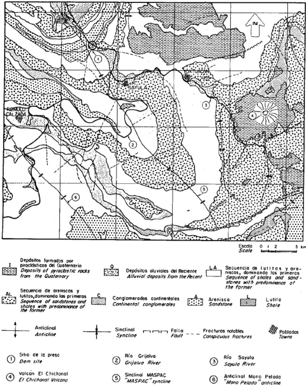
Fig. 3.32. Geología de Peñitas, (Tomada de Comportamiento de presas construidas en México, 1985).
