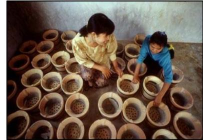
Las estufas prefabricadas combinan algunas de las ventajas de las estufas construidas artesanalmente y las locales, las partes principales de la estufa (comúnmente cerámica), son elaboradas artesanalmente de acuerdo a indicaciones precisas, el usuario adquiere algunas partes y las ensambla en su cocina.
