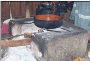
Mediante la prueba de ebullición de agua, en este tipo de estufas se logra un mejor funcionamiento que en las de fuego abierto, alcanzando eficiencias de alrededor del 20%. Esto se logra principalmente a que se disminuyen las pérdidas de calor debidas al aire circundante.
