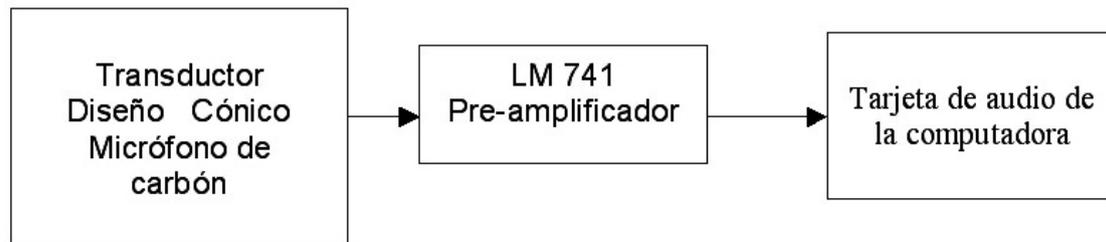
Figura no 4. Diagrama de bloques de la distribución del estetoscopio.
